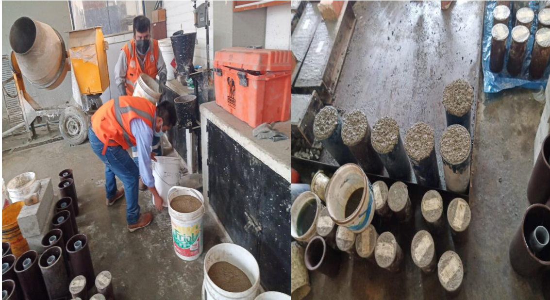
Figura 13. Vaciado de 45 probetas.
