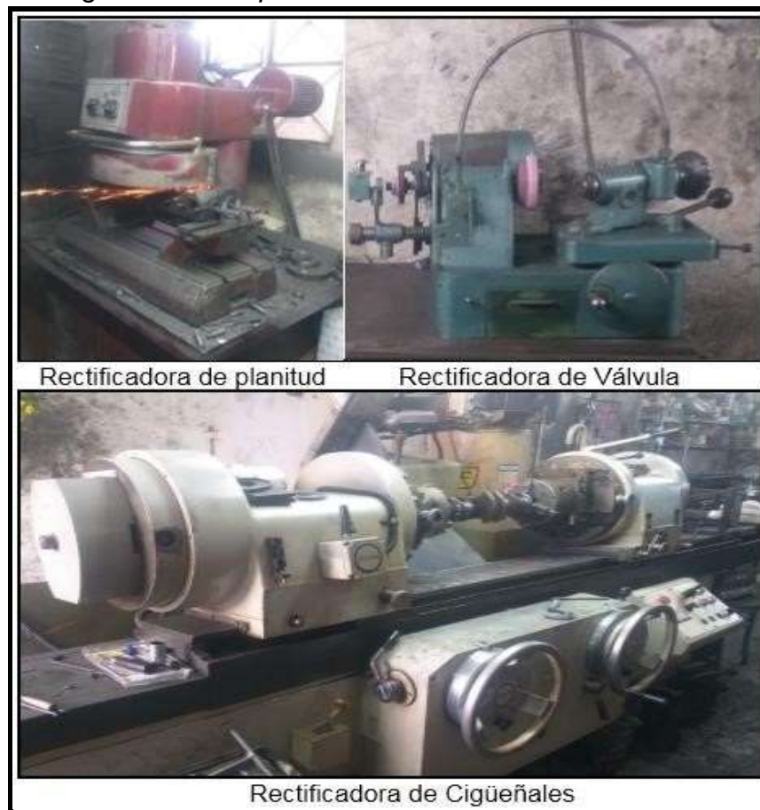
Figura N°6. Maquinas rectificadoras de motor.
