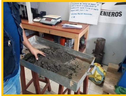
FOTOGRAFÍA N°17: PREPARACIÓN DE MEZCLA DEL SUELO MAS CBCA.
