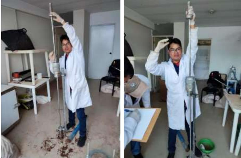
La evidencia que muestra las figura 15 en ella se realiza la utilización del instrumento PDC, una vez llenado con material dosificado el molde proctor se levanta el martillo de 8kg hasta la altura máxima y dejar caer realizar esta misma operación por 3 veces
