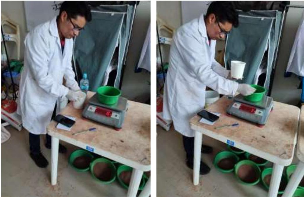
La evidencia que muestra la figura 11 es la aplicación de la dosificación de suelo 800 gramos. Más agua en (112, 96, 72, 16, gramos). con adición de caseína 2%, 5%, 12%, realizando un total de 12 muestras con la finalidad de medir la resistencia del CBR
