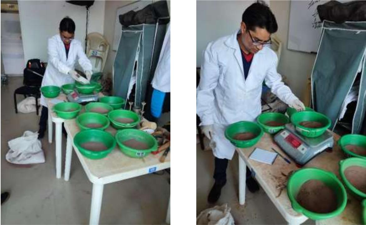
La evidencia que muestra la figura 10 es la realización de la distribución del material seleccionado en proporciones iguales según peso considerando 800 gramos del material limo arcilloso en 12 recipientes para sus distintas dosificaciones para su aplicación de caseína y agua.
