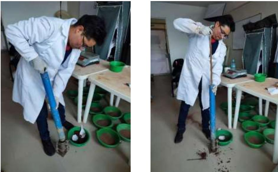
La evidencia que muestra la figura 14 con la finalidad de compactar el material dosificado se requiere la utilización del pisón de 2.5kg con una caída de 300 mm
