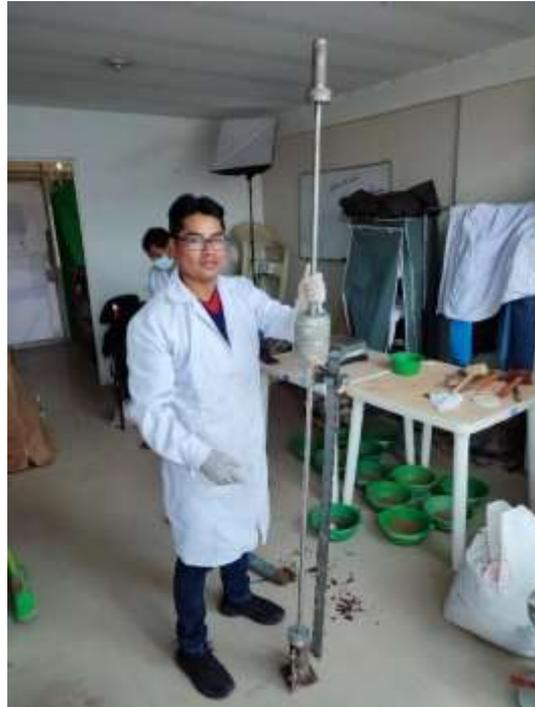
La evidencia que muestra la figura 8 es el principal instrumento PDC que se utilizó para realizar los trabajos en laboratorio con la finalidad de Comprobar la resistencia del suelo natural a los materiales compactados. El instrumento PDC, utilizado para evaluar el CBR
