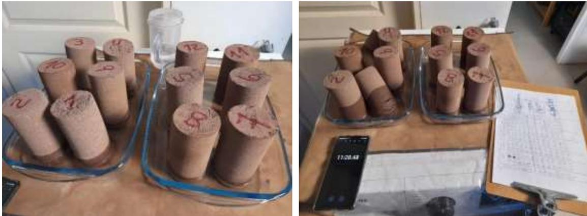
La figura 18 evidencia que las 12 muestras del suelo, caseína y agua ya secas son sometidas al mismo tiempo a una película de agua de un cm durante 30 minutos posterior aplicando un calibrador se toma las medidas con la finalidad de obtener datos para hallar la capilaridad
