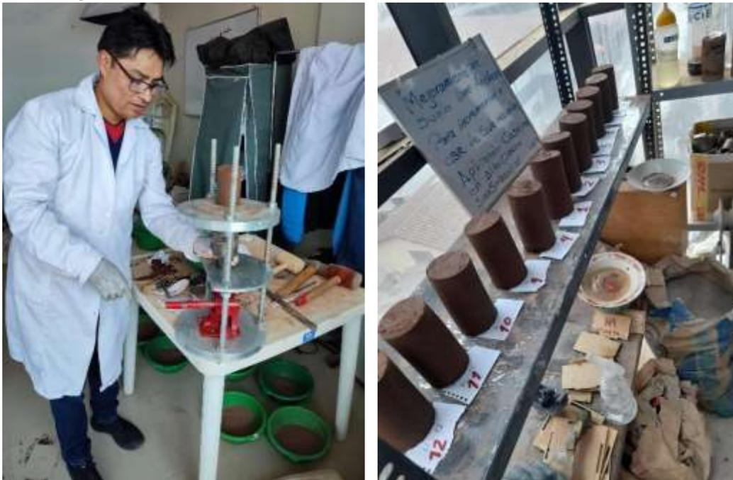
En la figura 17 se evidencia la utilización del extractor de muestra para las doce muestras que han sido retiradas con mucho cuidado puesto que están húmedas como podemos visualizar en la figura dos realizadas con distintas dosificaciones para posteriormente ingresar al horno durante 24 horas para realizar las pruebas respectivas.
