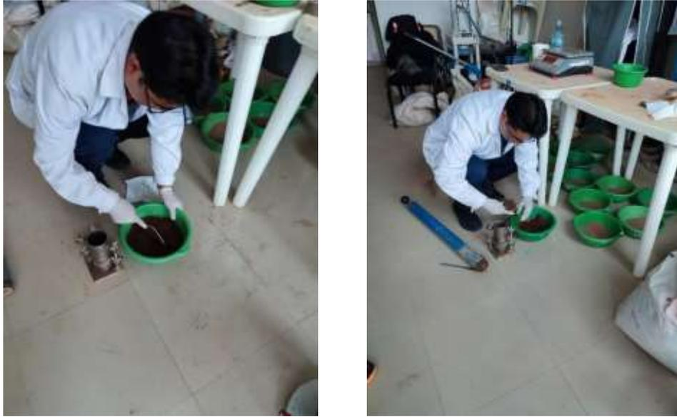
La evidencia que muestra la figura 13 es la del proceso de dividir el material dosificado con los componentes suelo, caseína y agua en 5 partes calculando que sean iguales, para posteriormente con un cucharón ser introducidas en el molde proctor para posteriormente utilizar el pisón,
