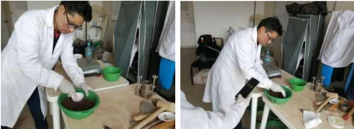
la evidencia que muestra la figura 12 es la aplicación de los elementos suelo, agua, caseína. posteriormente realizar un mesclado homogéneo en dos etapas cada una de ellas por un minuto y medio que al finalizar este proceso cumplan con 3 minutos
