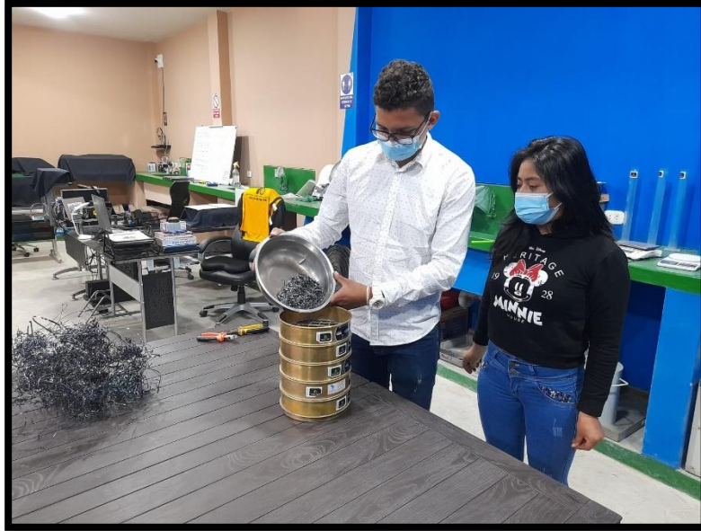
Figura 5. Tamizado de las fibras de acero
