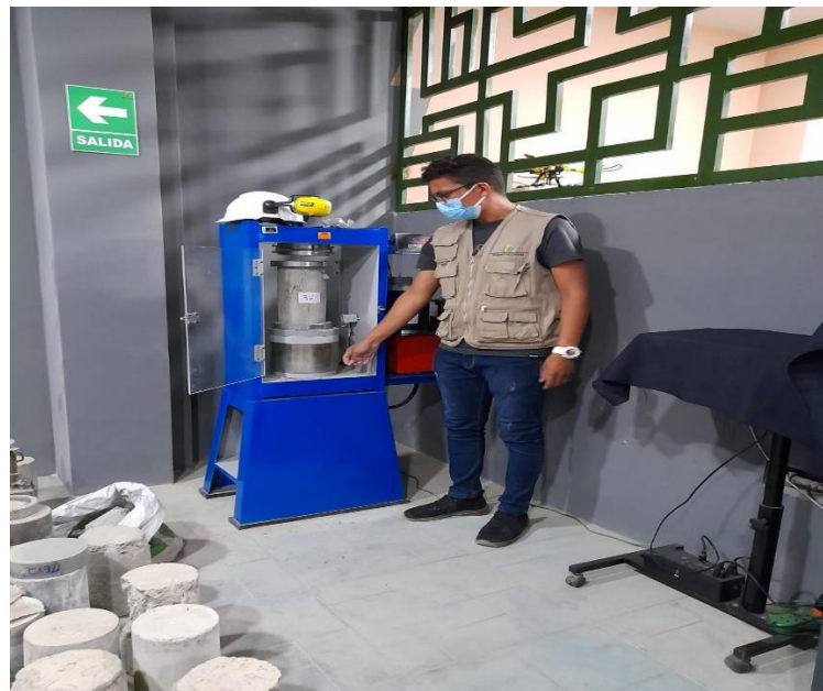
Figura 9. Rotura de Probetas.
