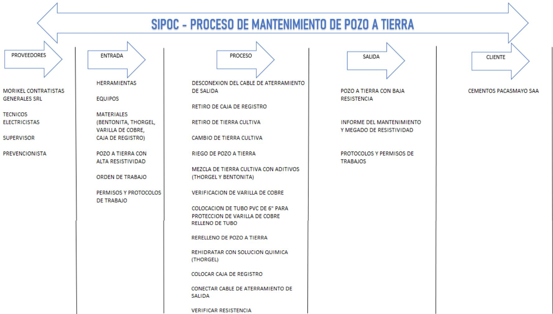
Figura N°7: DIAGRAMA SIPOC – MANTENIMIENTO POZO A TIERRA
