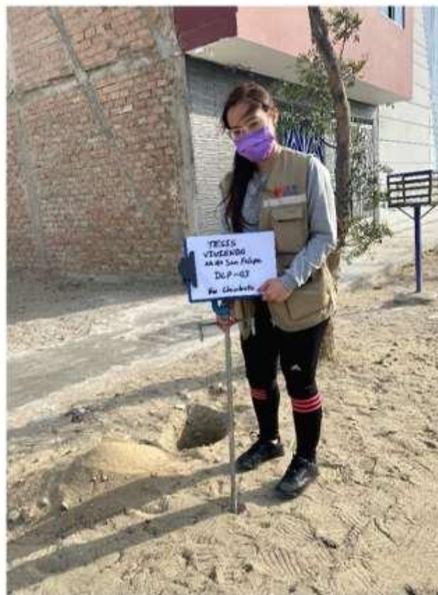
Foto N°06: Vista de ubicación de la Auscultación DPL-3, de compacidad compacta a densa.
