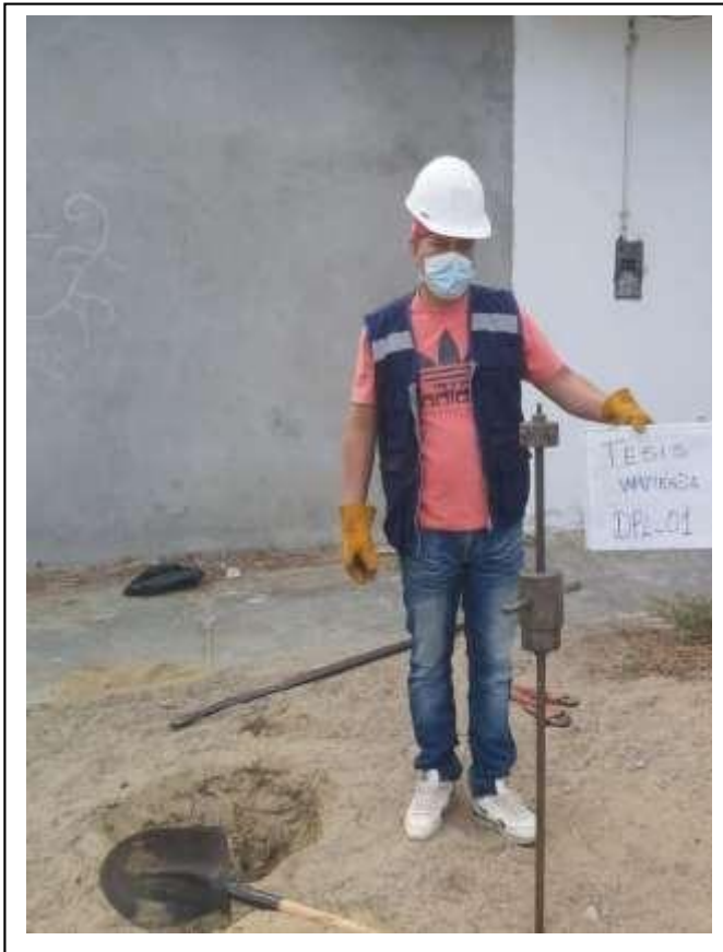
Foto N°03: Vista de ubicación de la C-02, presencia de material de relleno (afirmado) de 0.00 a 0.30m, seguido de un suelo arena mal graduada (SP) de compacidad compacta a densa, ligeramente húmeda y de color beige claro de 0.30 a 3.20m.
