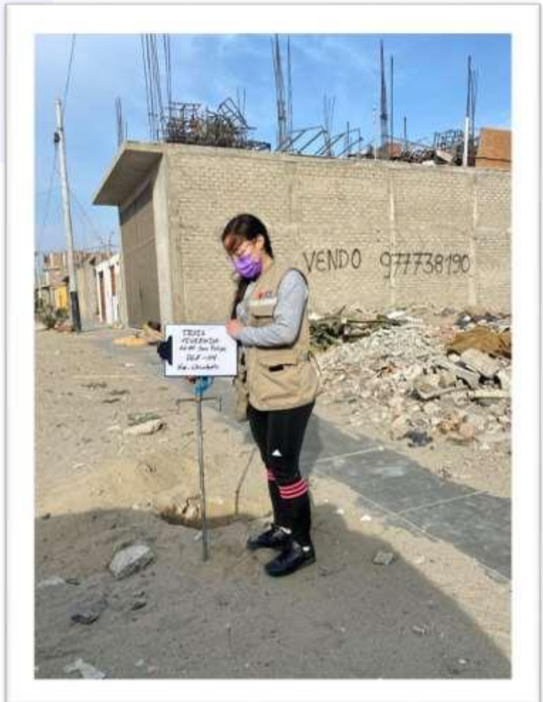
Foto N°08: Vista de ubicación de la Auscultación DPL-4, de compactación compacta a densa.
