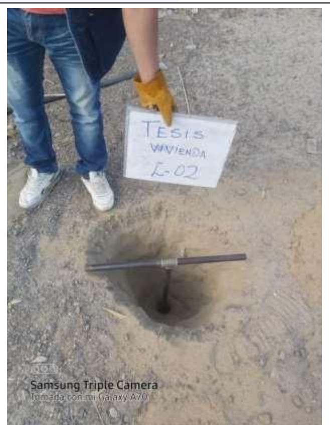
Foto N°04: Vista de ubicación de la Auscultación DPL-2, de compacidad compacta a densa.
