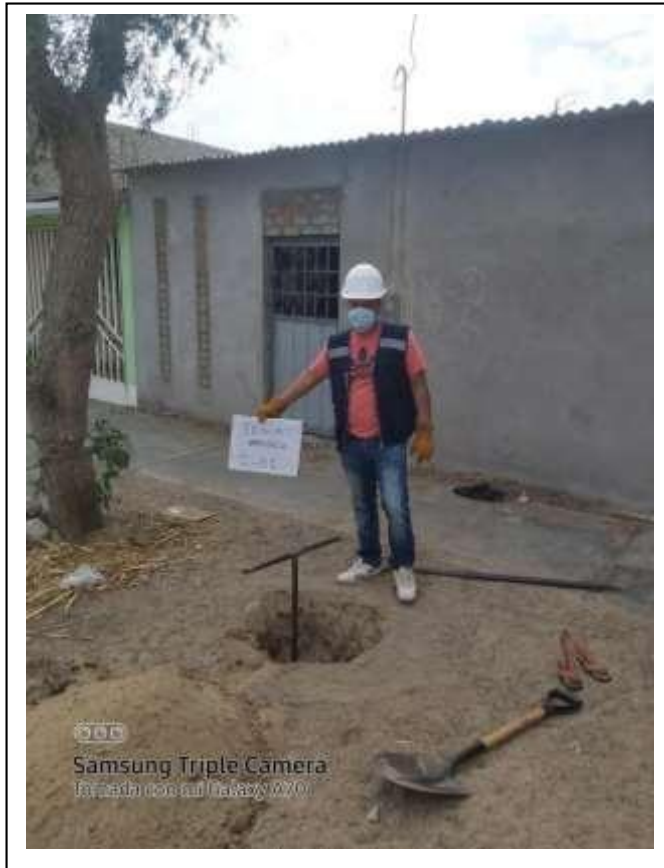
Foto N°01: Vista de ubicación de la C-01, presencia de terreno natural con raíces y gravas aisladas de 0.00 a 0.20m; seguido de un suelo arena mal graduada (SP) de compacidad compacta a densa, ligeramente húmeda y de color beige claro de 0.30 a 3.00m.
