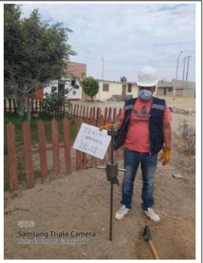
Foto N°01: Vista de ubicación de la C-01, presencia de terreno natural con raíces y gravas aisladas de 0.00 a 0.20m; seguido de un suelo arena mal graduada (SP) de compacidad compacta a densa, ligeramente húmeda y de color beige claro de 0.30 a 3.00m.
