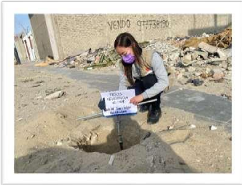
Foto N°07: Vista de ubicación de la C-04, presencia de material de relleno (afirmado) de 0.00 a 0.20m, seguido de un suelo arena mal graduada (SP) de compactación compacta a densa, ligeramente húmeda y de color beige claro de 0.20 a 3.00m.
