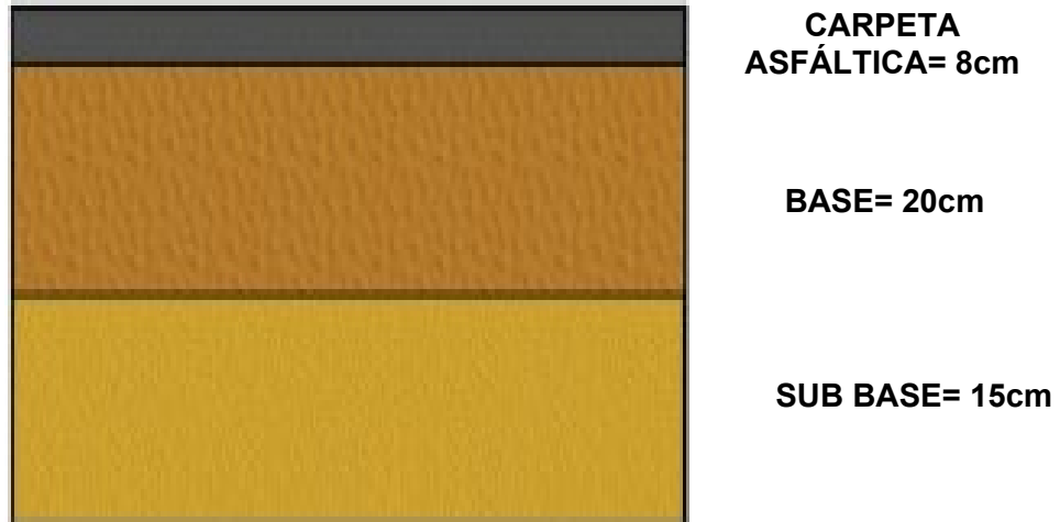
Figura N°10. Espesores del paquete estructural del pavimento
