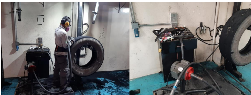
Figura 24: Estación de Escariado (situación Antes).
