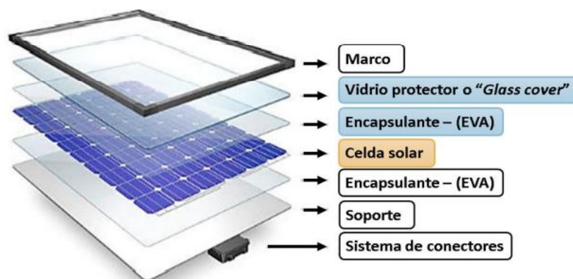
Figura 6: Partes que conforman los paneles fotovoltaicos
