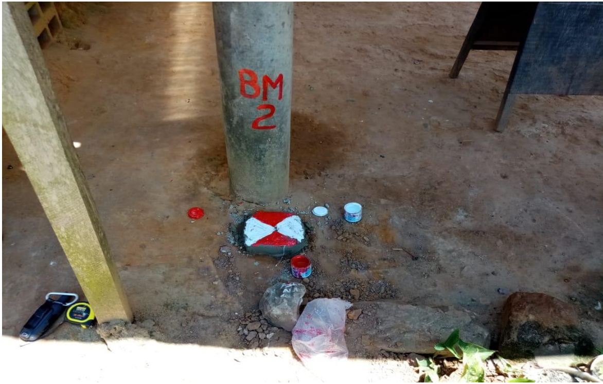
Figura 7: Ubicación del BM 02 con hito de concreto y núcleo de acero
