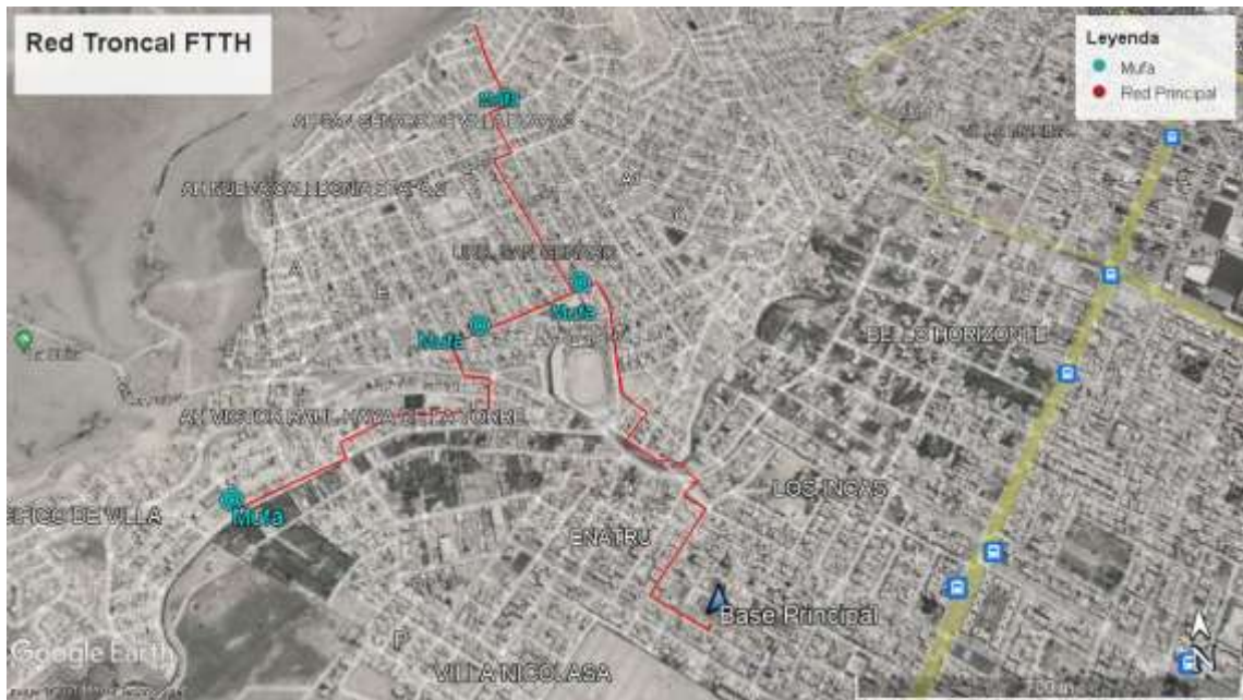
Figura 26: Detalle del tendido de la Red troncal o principal.
