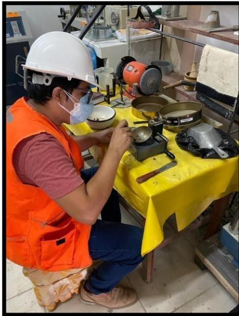
En la foto 29 y 30 se procede a humedecer la muestra (arcilla) para realizar el ensayo de limite liquido.
