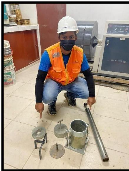
En la foto 23 y 24 se observa a los tesistas con los instrumentos para realizar el ensayo de Proctor modificado.
