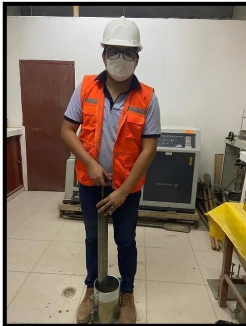
En la foto 25 y 26 se observa a los tesistas, realizando la compactación de la muestra para el ensayo de Proctor modificado.
