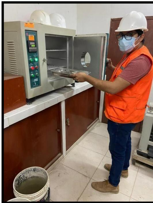
En la foto 33 y 34 se colocan al horno las muestras del ensayo limite plástico.
