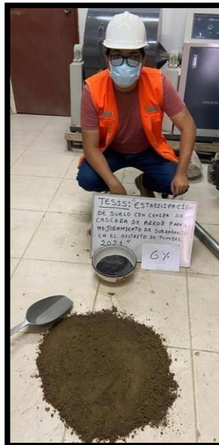
La foto 9 y 10 se observa el material de subrasante y se muestra el material de ceniza de cascara de arroz con su porcentaje para realizar el mezclado y luego la compactación.
