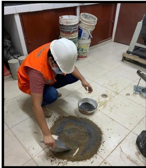
La foto 11 y 12 se observa mezclado el material de subrasante y se muestra el material de ceniza de cascara de arroz con los porcentajes 4% y 6% luego la compactación.
