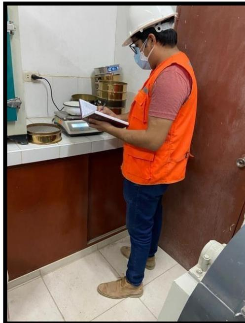
En la foto 27 y 28 se procede hacer el tamizaje y toma de datos para el ensayo de limite líquido y limite plástico.
