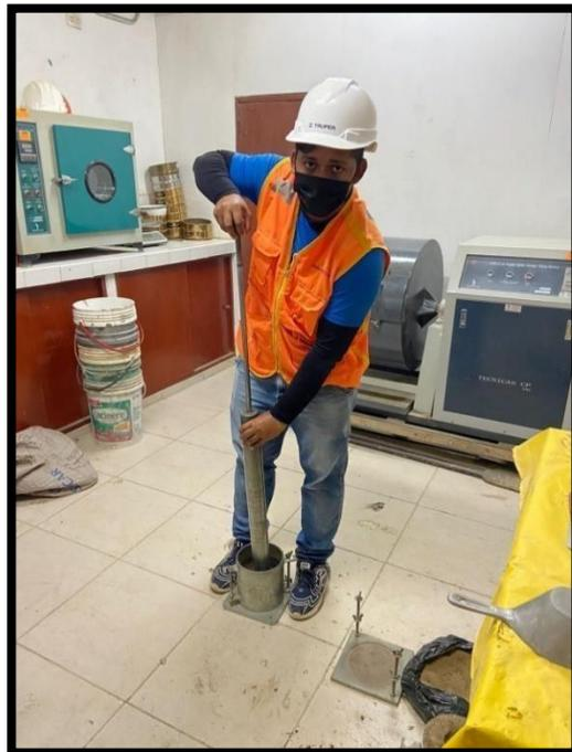
En la foto 13 y 14 los tesistas realizan el ensayo la compactación para el ensayo de CBR.
