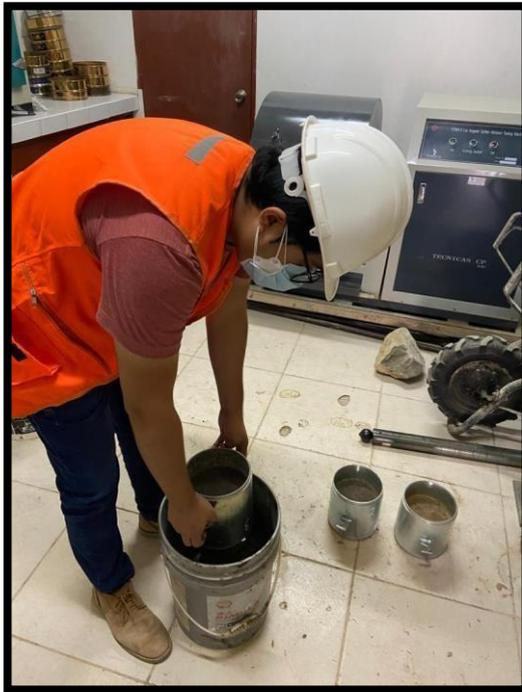
En la foto 15, 16, 17 y 18 se culminó la compactación y se empieza a sumergir en agua las muestras para el ensayo de CBR.
