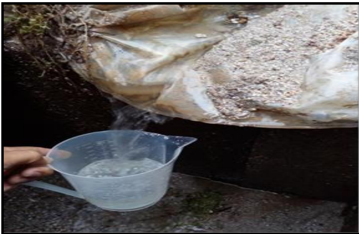
VISTA DE PROCESO DE MEDICION DE CAUDAL - MANANTIAL SHUYTUPATA
