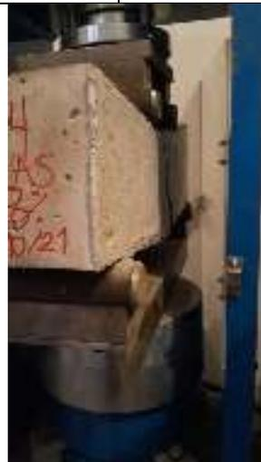
Figura 35. Rotura de viga de ensayo a flexión
