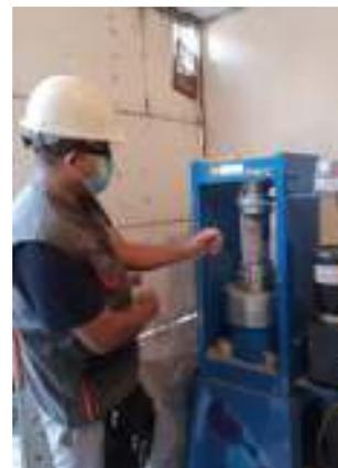
Figura 37. Ensayo a compresión a los 28 días – adicionando 5%
