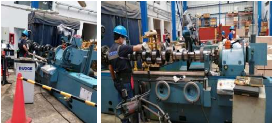
Figura 25. Sub-área de pulido y rectificado de cigüeñal
