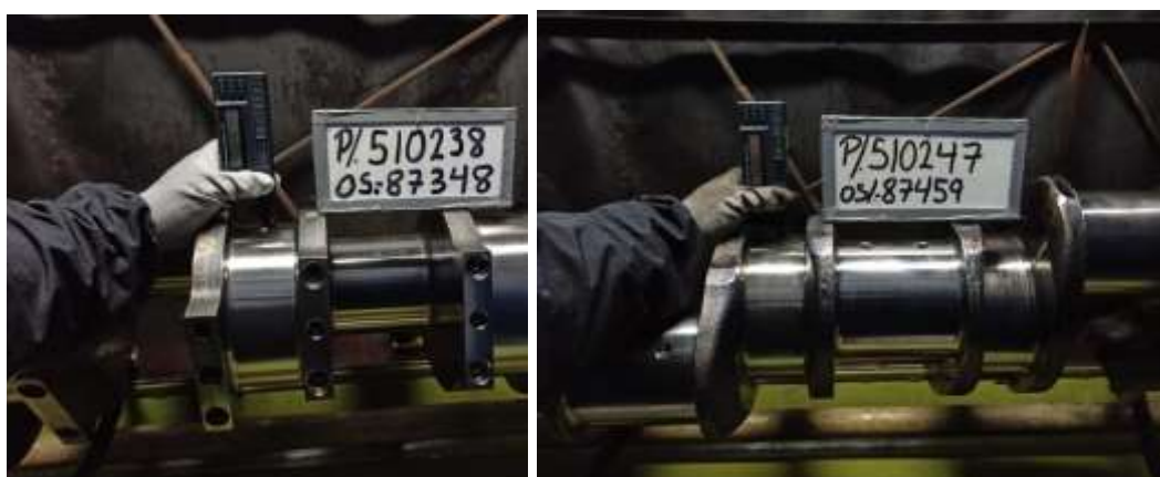
Figura 31. Calibración de dureza a puños de cigüeñal
