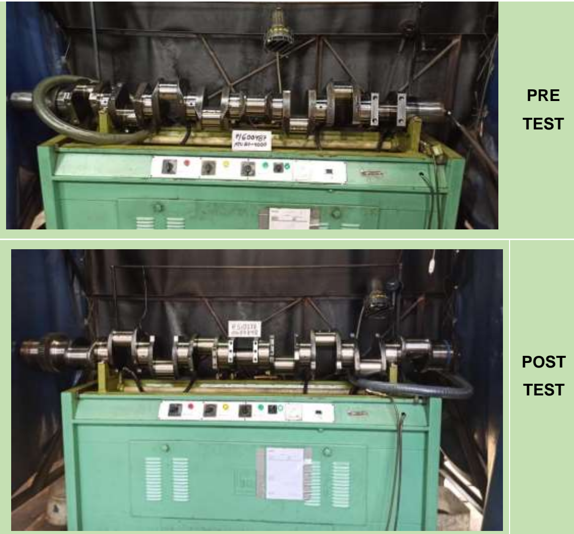
Figura 28. Máquina magnetoscópica de cigüeñal
