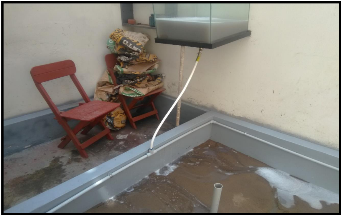
Distribución de la muestra en el humedal artificial de flujo vertical (prueba piloto)
