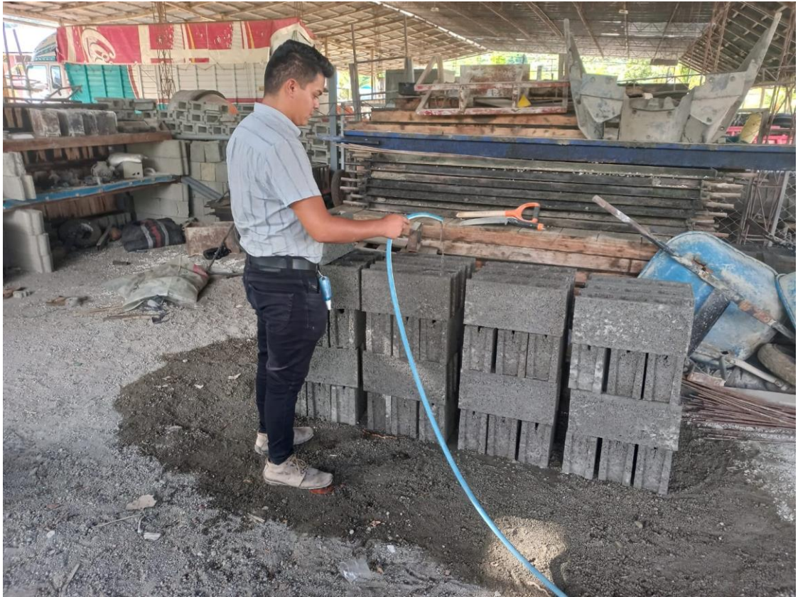
Figura 23: curado de lotes de ladrillos
