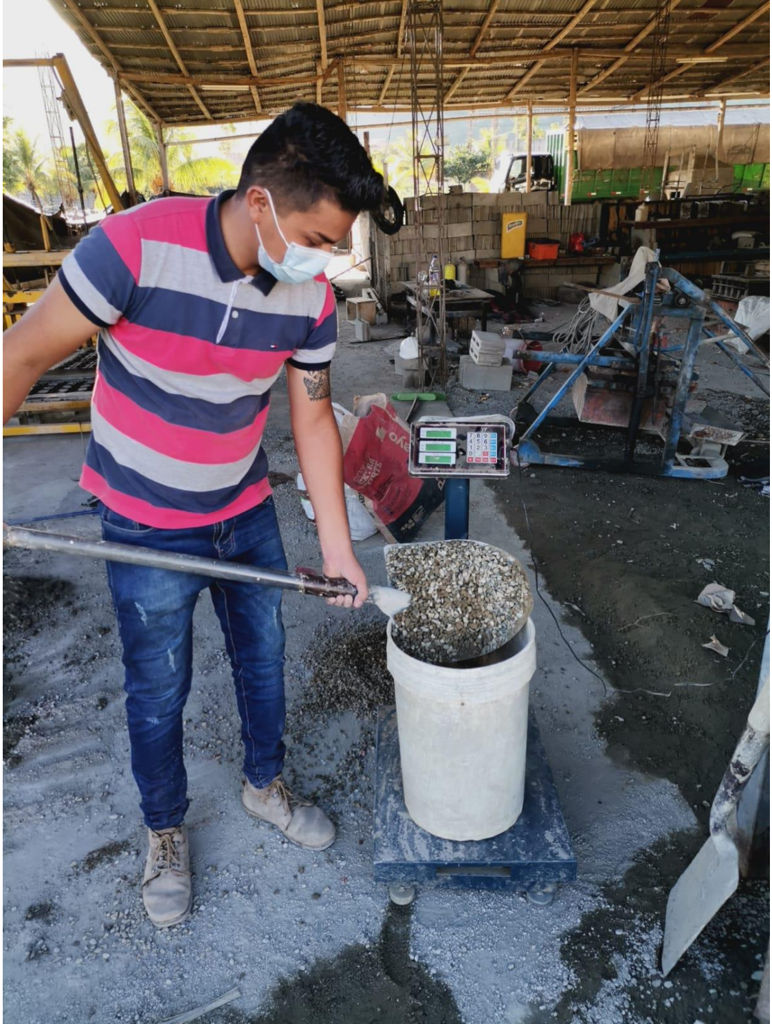
Figura 10: Pesado de las dosificaciones de agregados para la mezcla
