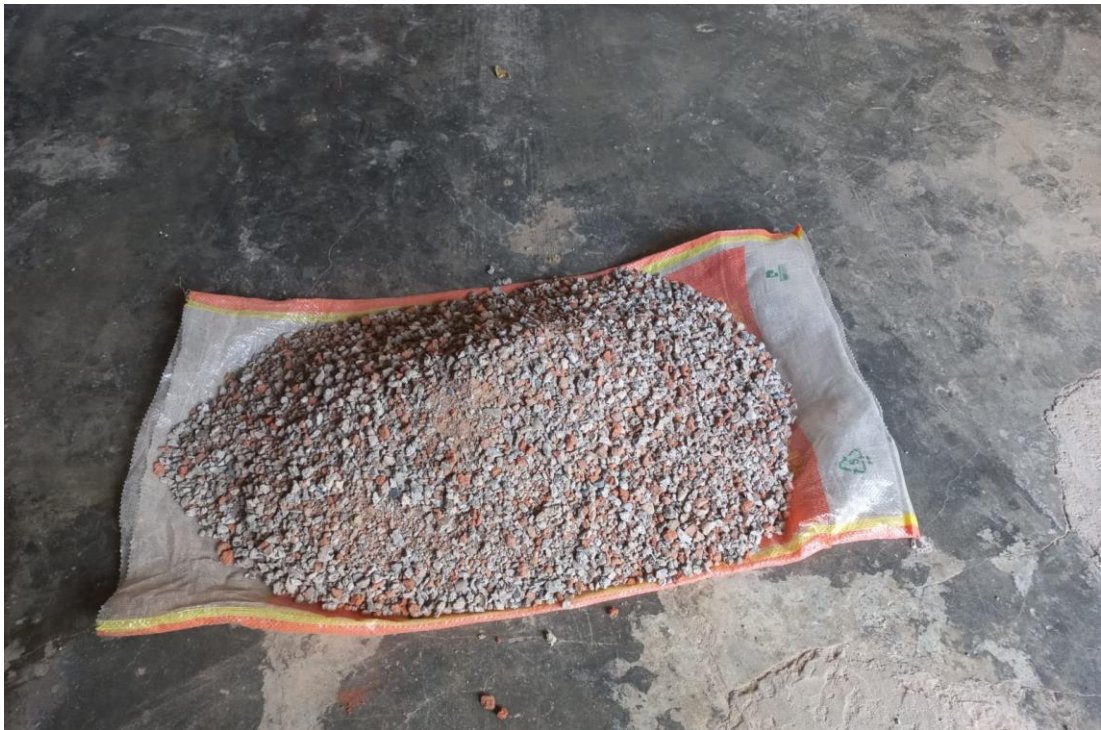
Figura N.º 4.7: Tamización hasta 3/8”
