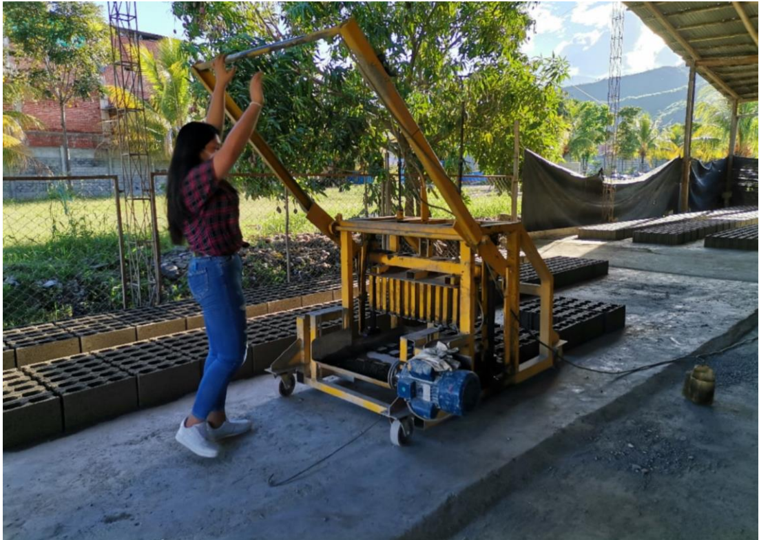
Figura 19: producción de cada lote patrón y con adición para cuatro tiempos de curado
