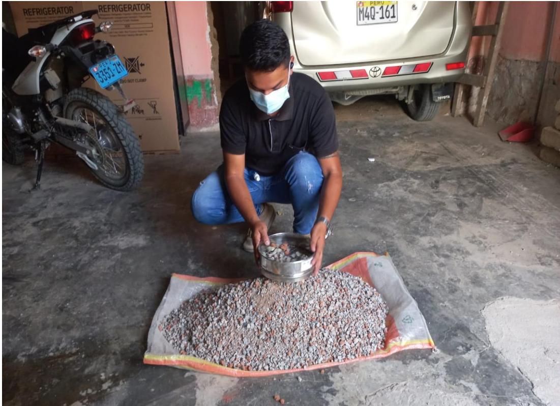
Figura N.º 4.7: Tamización hasta 3/8”
