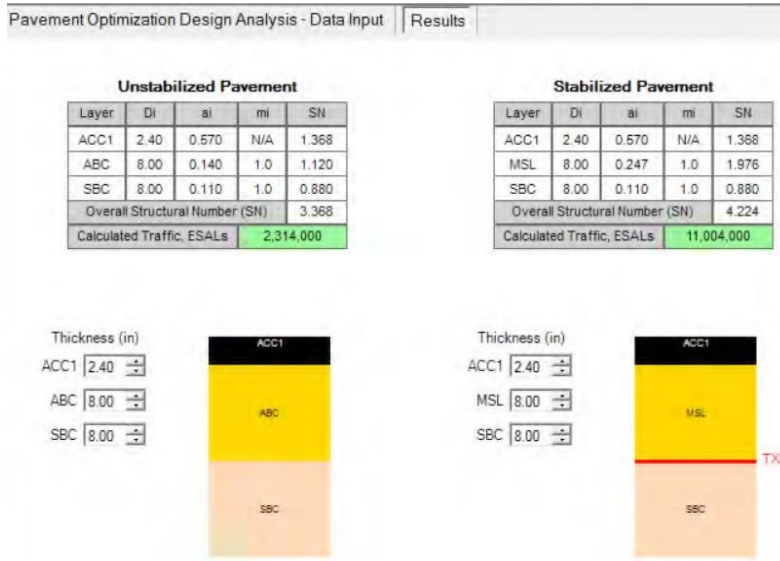
Figura 34: Aporte de uso de geomallas triaxiales conservando grosores de capas en software Spectra Pave4-Pro
