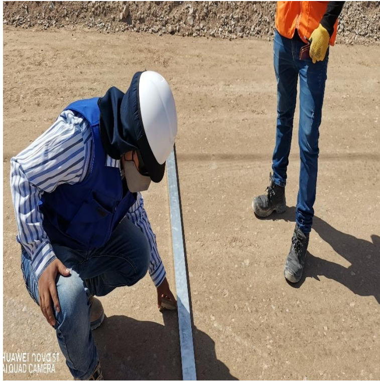
Figura 43: Obtención de datos de ancho de vía y deformaciones en campo.
