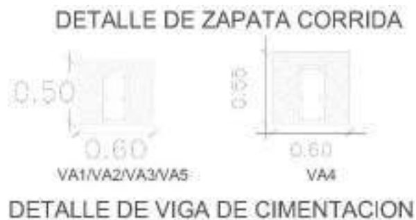
Figura 4: Vigas de cimentación
