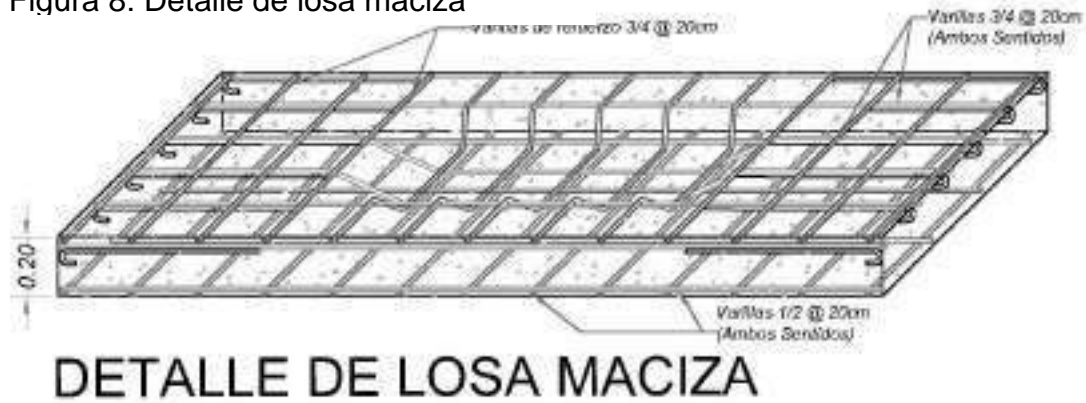
Figura 8: Detalle de losa maciza
