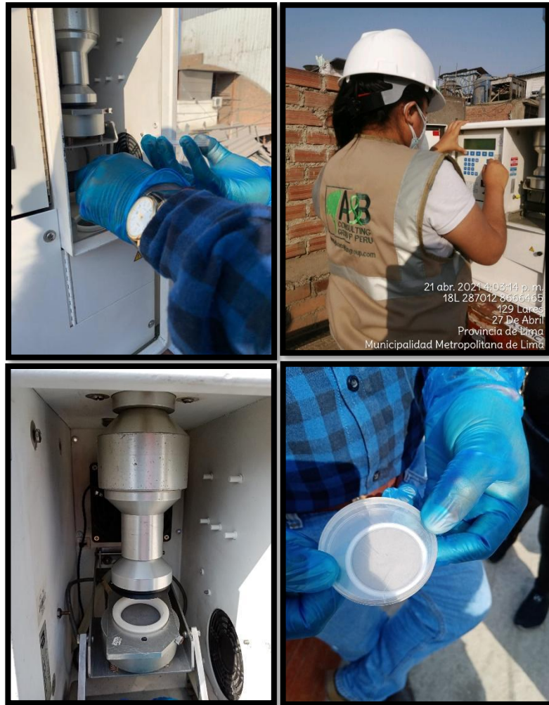
Figura 13. Colocación y retiro del filtro de teflón del equipo Low-Vol
