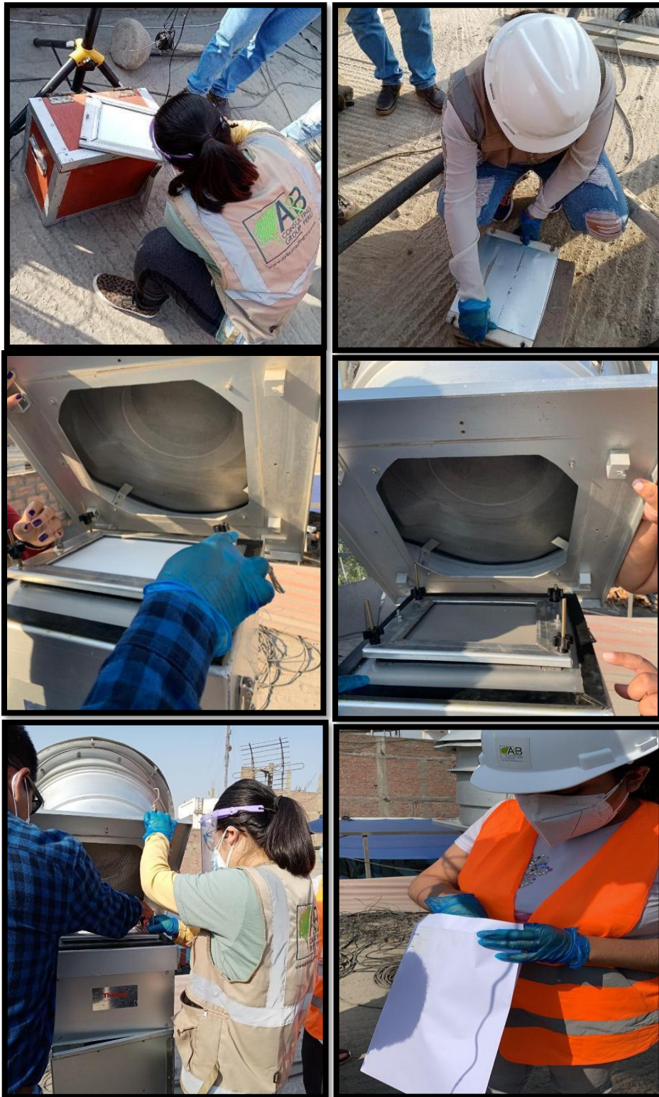
Figura 11. Colocación y retiro del filtro de fibra de cuarzo del equipo Hi-Vol
