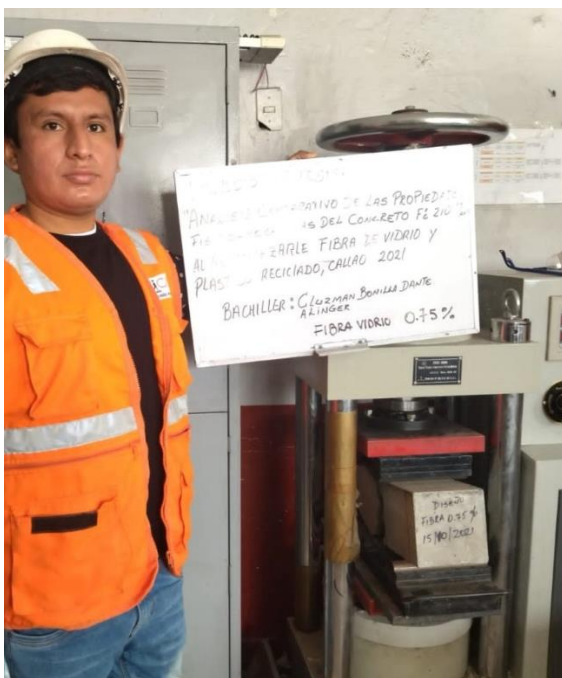
Figura 13: Ensayo a flexion F.V
