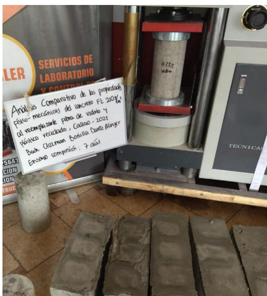
Figura 7: Ensayo a compresion Fuente: Elaboración propia
