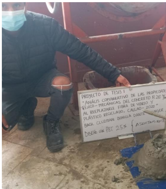
Figura 17: Ensayo de consistencia
