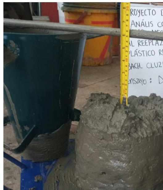
Figura 18: Asentamiento de la mezcla
