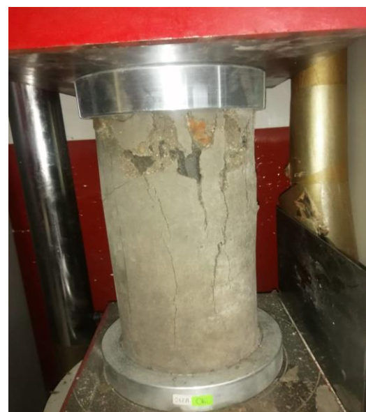
Figura 8: Falla de la probeta Fuente: Elaboración propia
