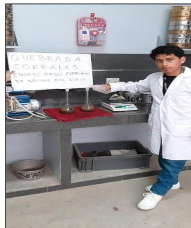
Ensayo de Peso Específico de Sólido de suelos
