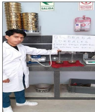
Ensayo de Peso Específico de Sólidos de suelos
