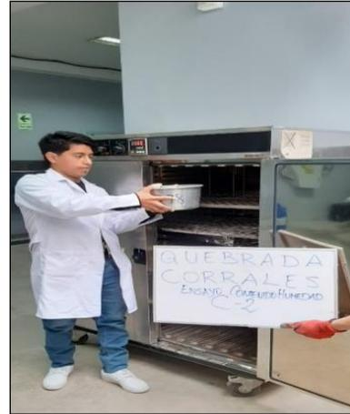
Ensayo de humedad
