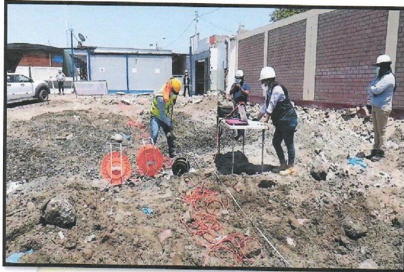
FOTOGRAFIAS 01, 02 Y 03: EJECUCION DEL ENSAYO DE REFRACCION SISMICA R-1
