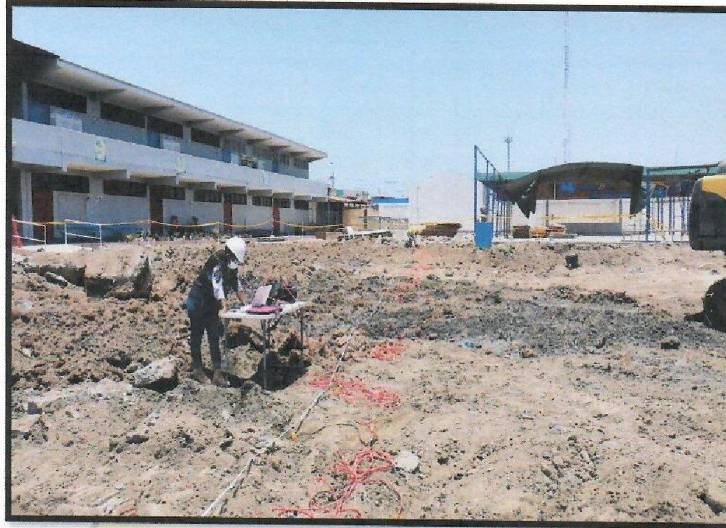
FOTOGRAFIAS 04, 05 Y 06: EJECUCION DEL ENSAYO DE REFRACCION SISMICA R-2
