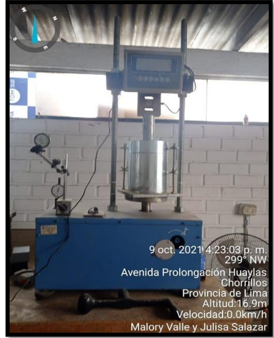
FOTO14: Maquina de prueba de compresión.
