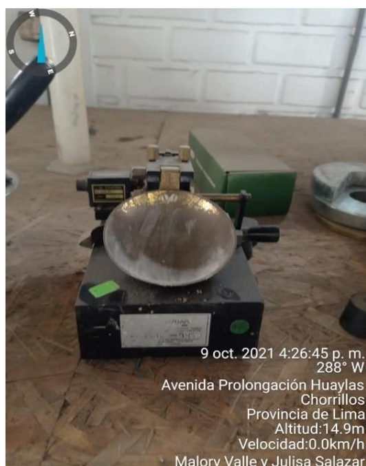
Figura 11. Cuchara de casa grande para el Índice de Plasticidad
