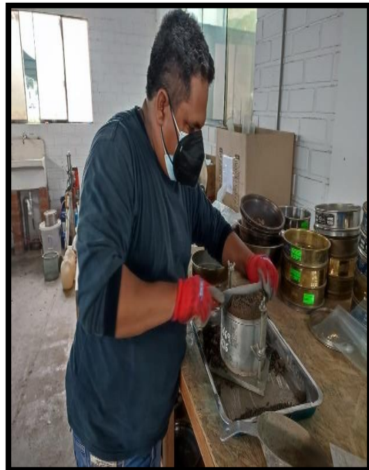
FOTO 12: Ensayo OCH y MDS incorporando fibra de cabuya Y Cal.
