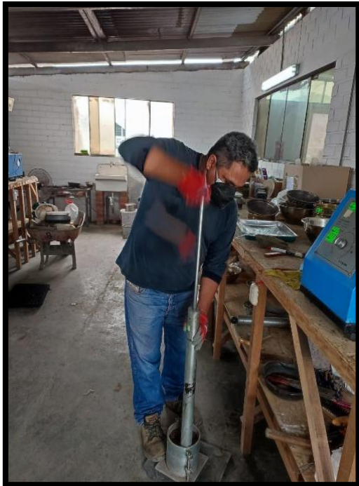
FOTO 11: Golpes en molde de compactación de CBR.
