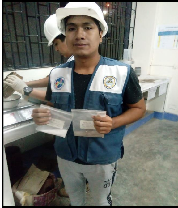
Concha de abanico y cáscara de arroz molidas para el ensayo de ATD.
