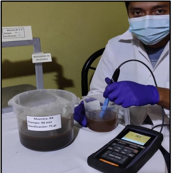
Figura 32. Registro de pH con el multiparámetro digital a las muestras desde la R-1 hasta R-4.
