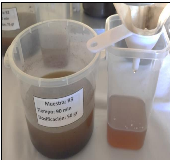
Figura 31. Filtrado de muestras desde R-1 hasta la R-4 respectivamente.
