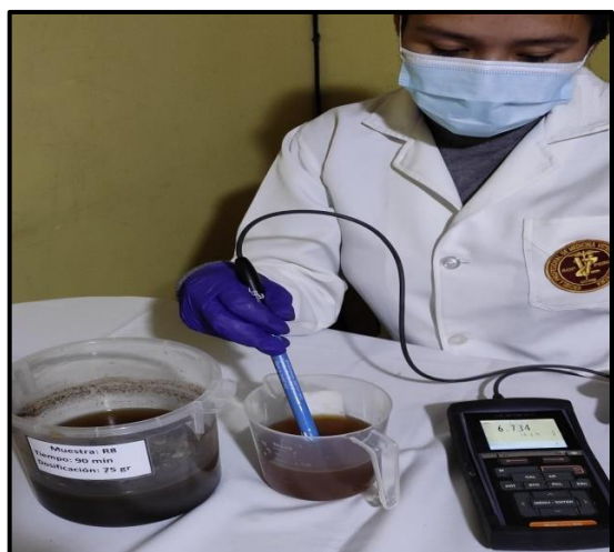
Figura 36. Registro de pH con el multiparámetro digital a las muestras desde la R-5 hasta R-8.
