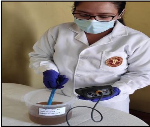
Figura 27. Toma de pH a la muestra R-0 y codificación.
