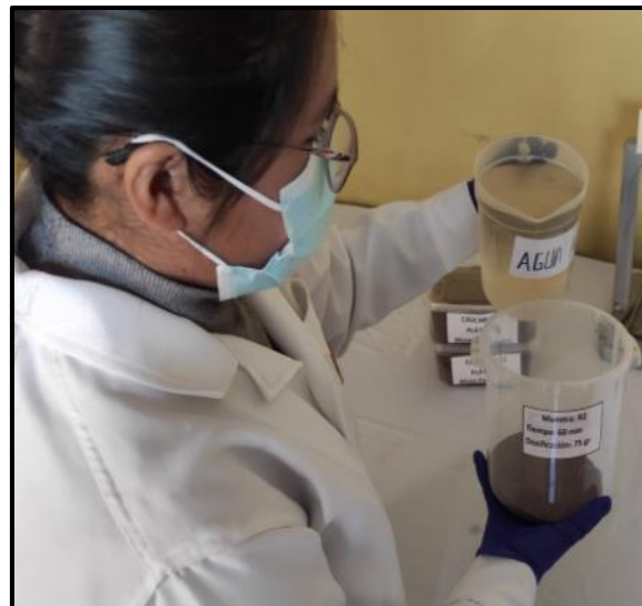
Figura 27. Toma de pH a la muestra R-0 y codificación.
