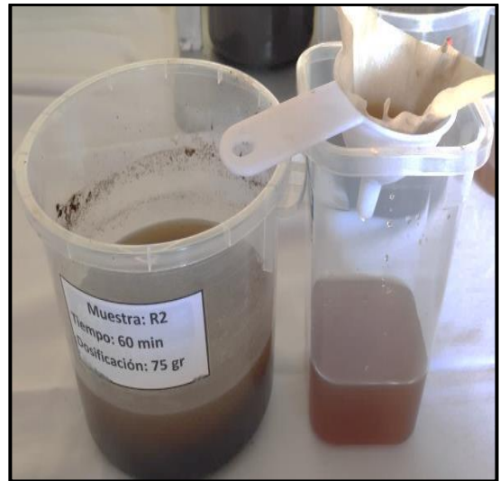
Figura 30. Preparación de papel filtro, recipientes y sedimentación de muestras.
