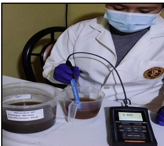
Figura 36. Registro de pH con el multiparámetro digital a las muestras desde la R-5 hasta R-8.
