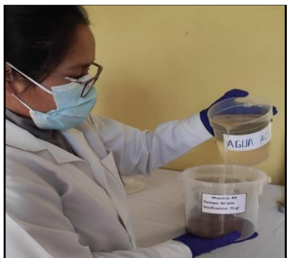
Figura 28. Mesclando de 1000ml de agua acida a los recipientes con su dosificación correspondiente desde la R-1 hasta el R-4 primer ensayo.
