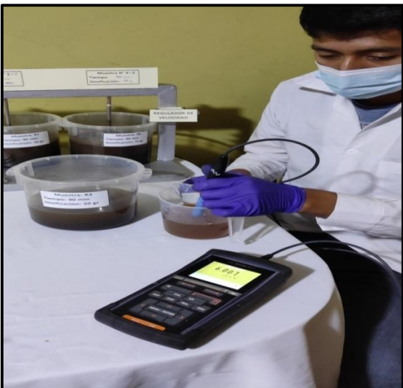
Figura 32. Registro de pH con el multiparámetro digital a las muestras desde la R-1 hasta R-4.
