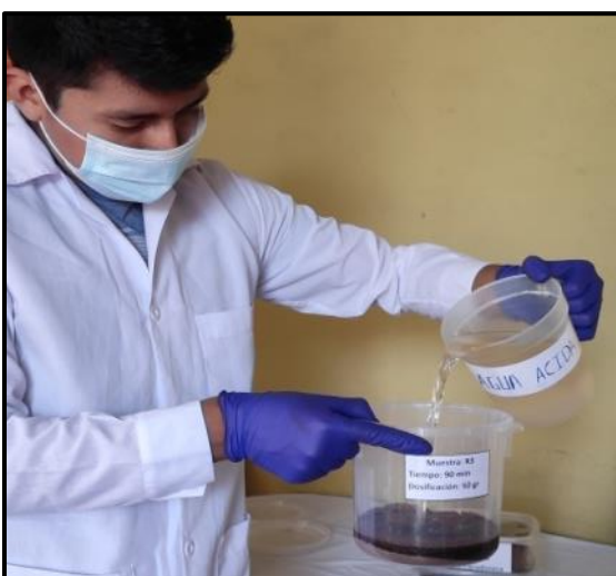
Figura 28. Mesclando de 1000ml de agua acida a los recipientes con su dosificación correspondiente desde la R-1 hasta el R-4 primer ensayo.
