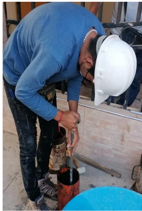
Figura 103. Elaboración de probetas – F'c = 210 \text{ kg/cm}^2 más 2.5 %de fibra de acero.
