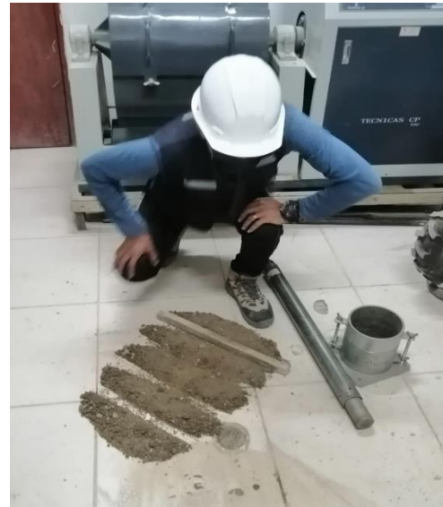
Figura 25. Realización del ensayo Proctor modificado
