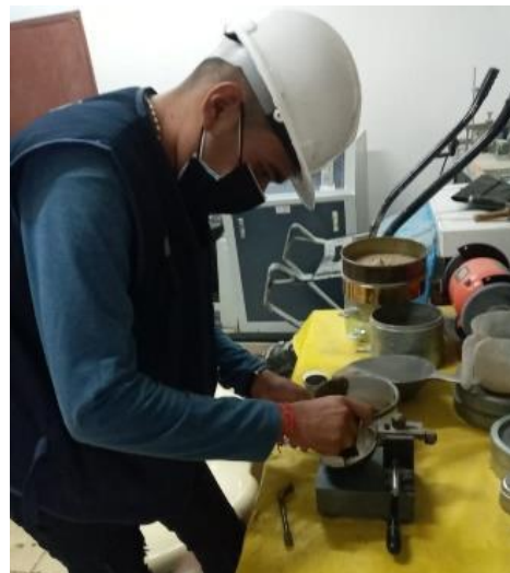
Figura 21. Realización del ensayo limite liquido
