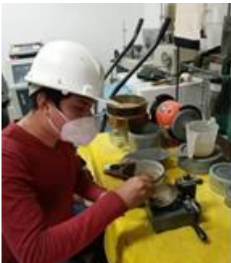
Figura 20. Realización del ensayo limite liquido
