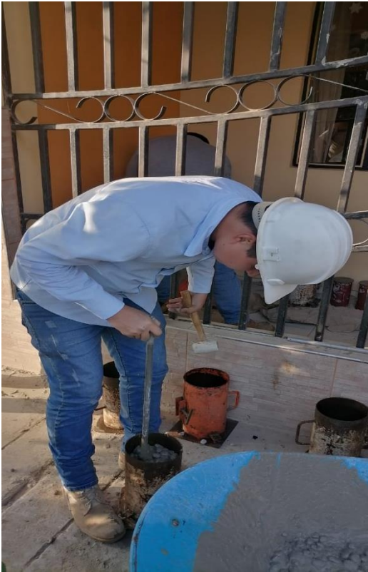
Figura 104. Elaboración de probetas – F'c = 210 \text{ kg/cm}^2 más 5 % de fibra de acero.
