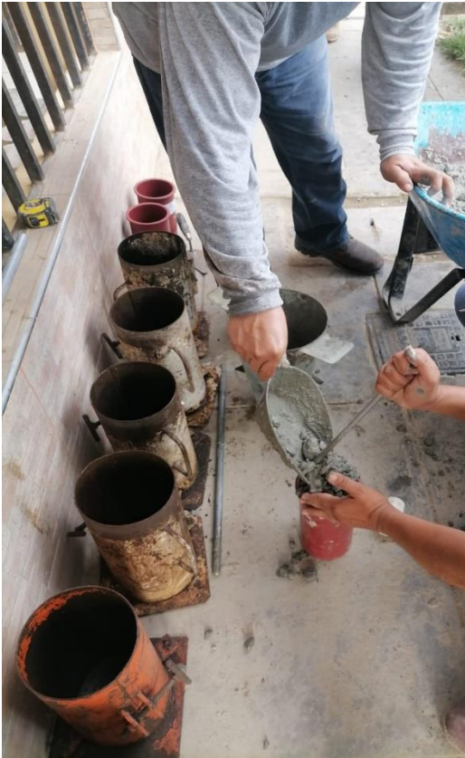
Figura 101. Elaboración de probetas con el concreto patrón – F'c = 210 \text{ kg/cm}^2 .
