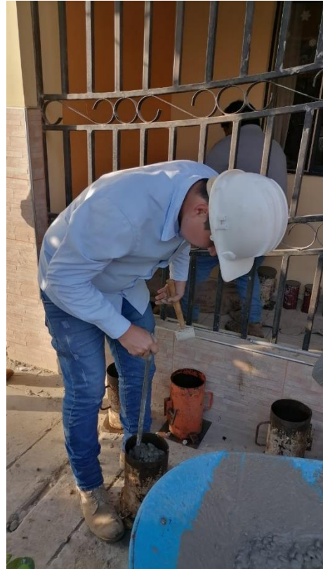
Figura 106. Elaboración de probetas – F'c = 210 \text{ kg/cm}^2 más 5 % de fibra de acero.
