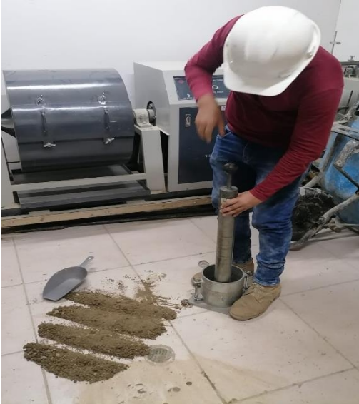
Figura 24. Realización del ensayo Proctor modificado
