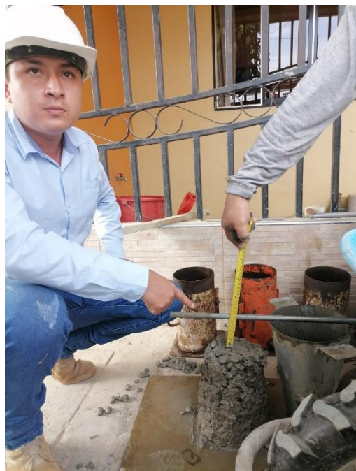
Figura 97. Ensayo cono de Abrams del concreto F'c = 210 \text{kg/m}^2 más 5 % de fibra de acero.
