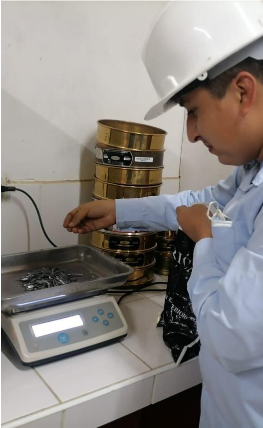
Figura 86. Peso de fibra de acero (Sika® Fiber CHO 80/60 NB).
