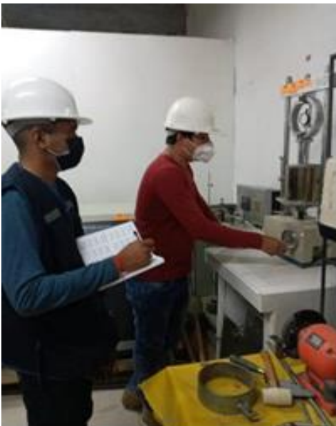
Figura 26. realización del ensayo de CBR.
