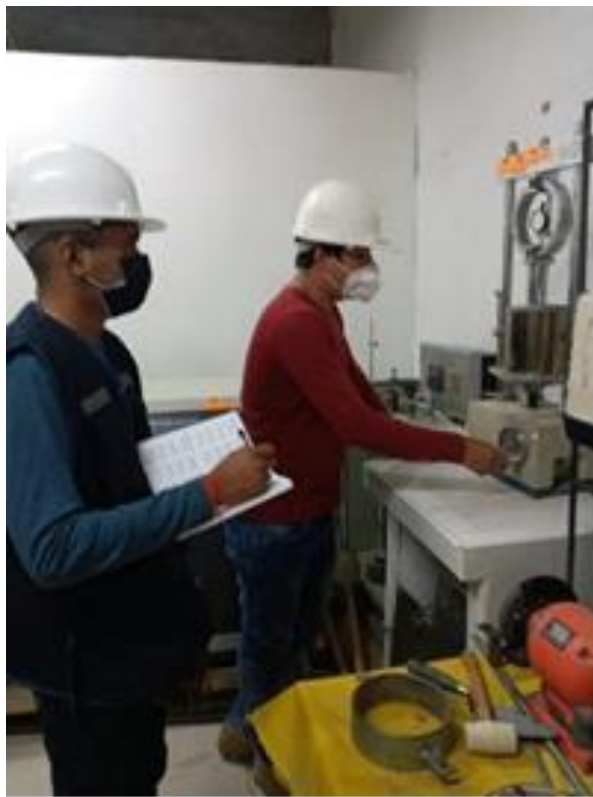
Figura 80. Ensayo de C.B.R.
