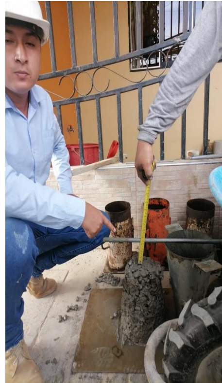
Figura 98. tomando medida de Islump del concreto patrón F'c = 210 \text{kg/m}^2 más 5 % de acero.
