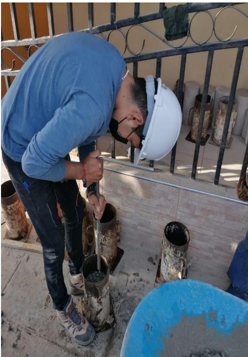
Figura 102. Elaboración de probetas – F'c = 210 \text{ kg/cm}^2 más 2.5 %de fibra de acero.
