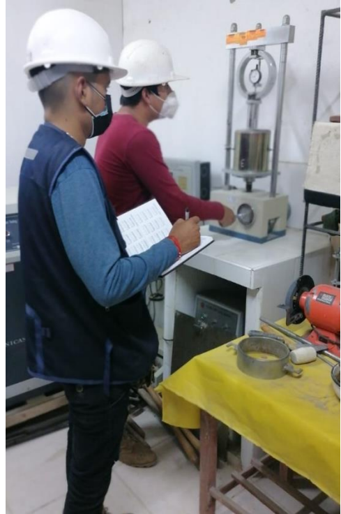
Figura 78. Ensayo de C.B.R.
