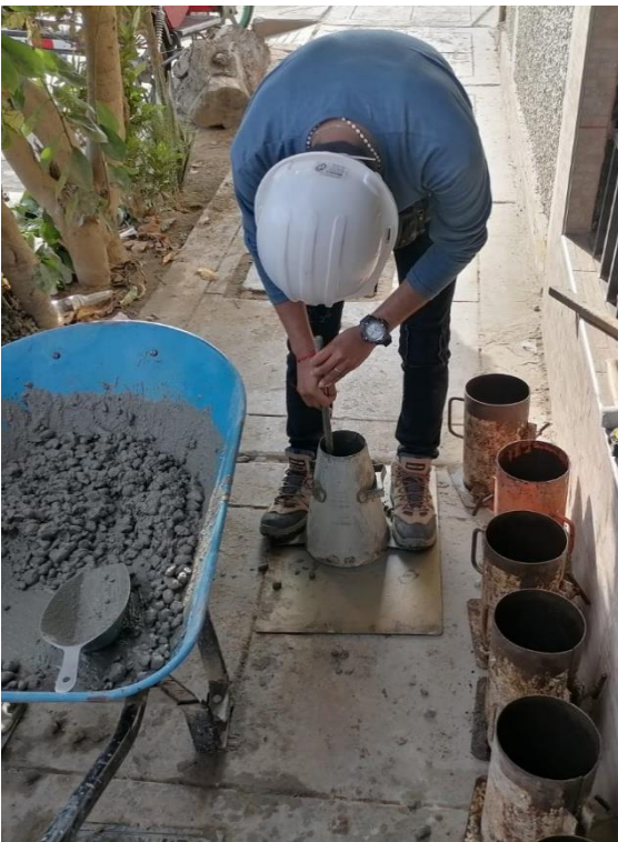
Figura 94. Ensayo cono de Abrams del concreto patrón F'c = 210 \text{ kg/m}^2
