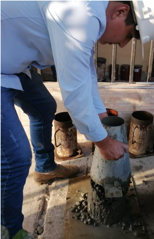
Figura 99. tomando medida de Islump del concreto patrón F'c = 210 \text{kg/m}^2 más 5 % de acero
