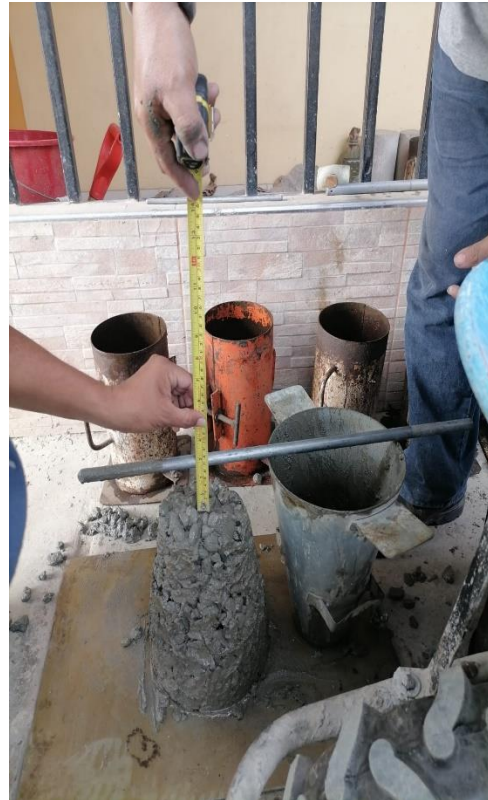
Figura 95. tomando medida de Islump del concreto patrón F'c = 210 \text{ kg/m}^2 más 2.5 % de acero.
