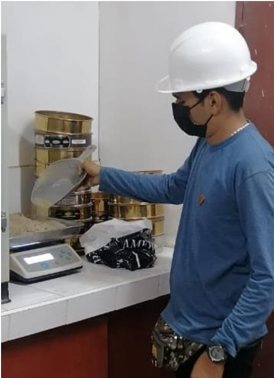
Figura 81. Pesos de agregados para el concreto.
