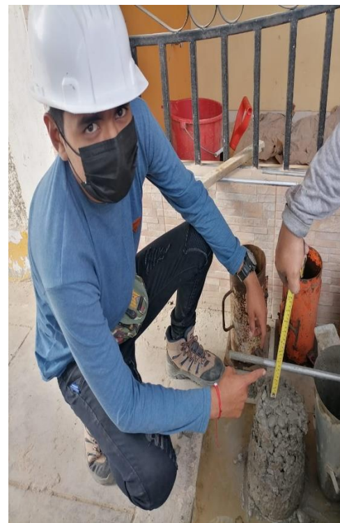
Figura 93. Tomando medida de Islump del concreto patrón F'c = 210 \text{ kg/m}^2 .
