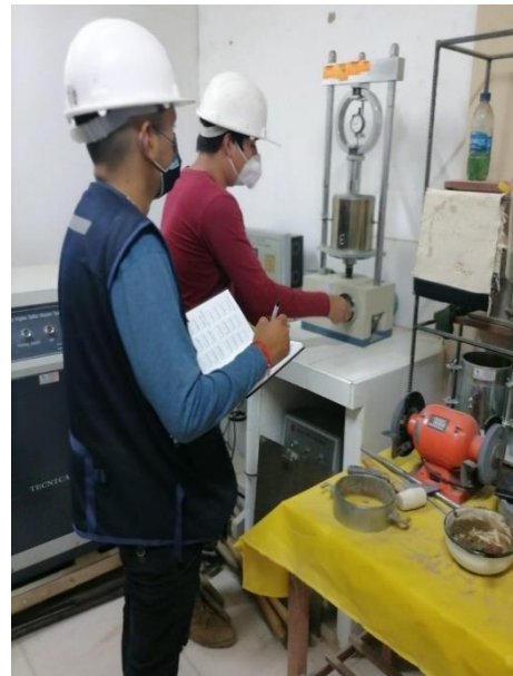
Figura 27. realización del ensayo de CBR.
