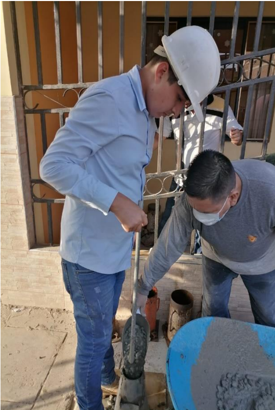
Figura 96. Ensayo cono de Abrams del concreto F'c = 210 \text{ kg/m}^2 más 2.5 % de fibra de acero.
