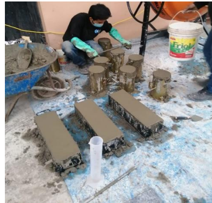
Figura 48. Realización de vigas y probetas.
