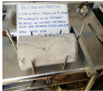
Figura 54. Fisura al ensayo de compresión
