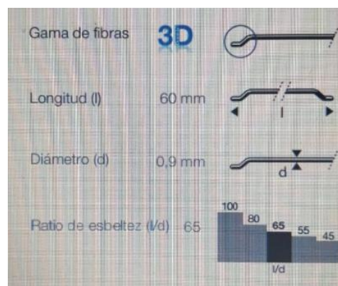
Figura 11: Geometría de la fibra
