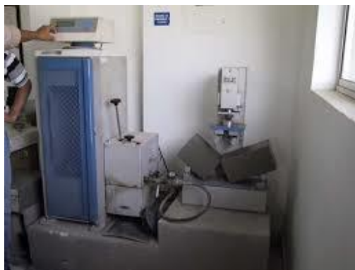
Figura 7: Resistencia a la compresión
