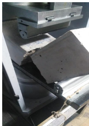
Figura 68. Viga en el proceso del ensayo
