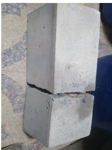
Figura 67. Viga con rotura ensayada
