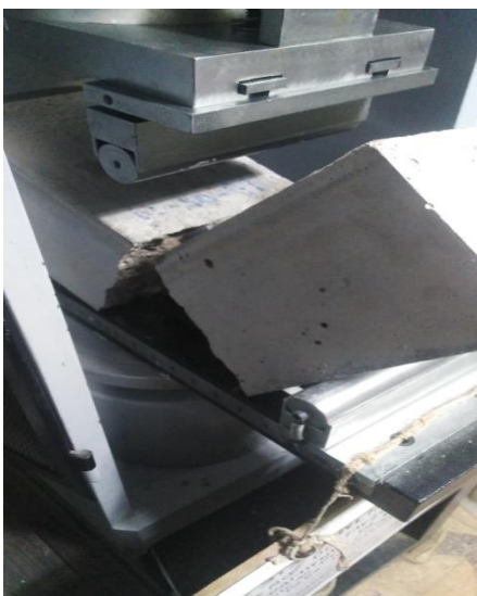
Figura 36. Rotura de ensayo a flexión
