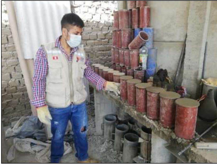
Figura 19. Elaboración de probetas cilíndricas.
