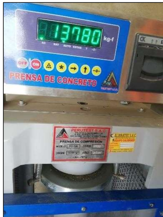
Figura 36. Resistencia a la compresión de probeta a 7 días
