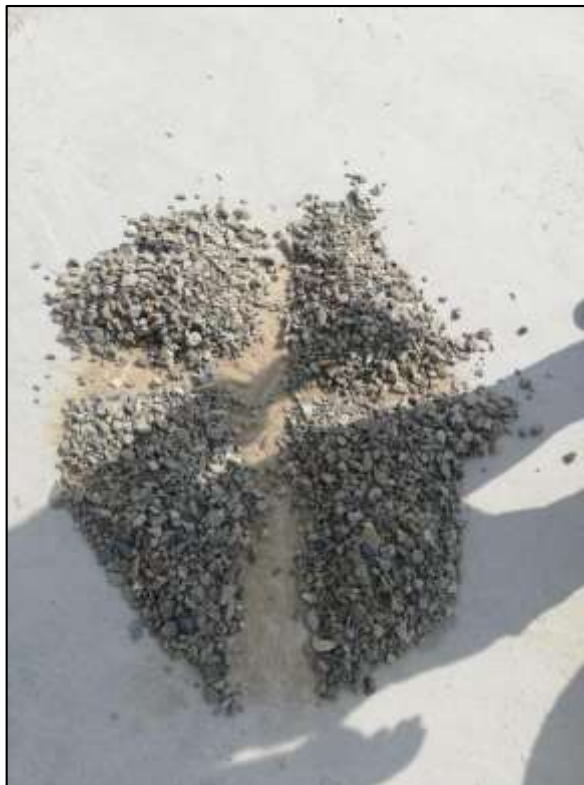
Figura 28. Cuarteo de material Grueso
