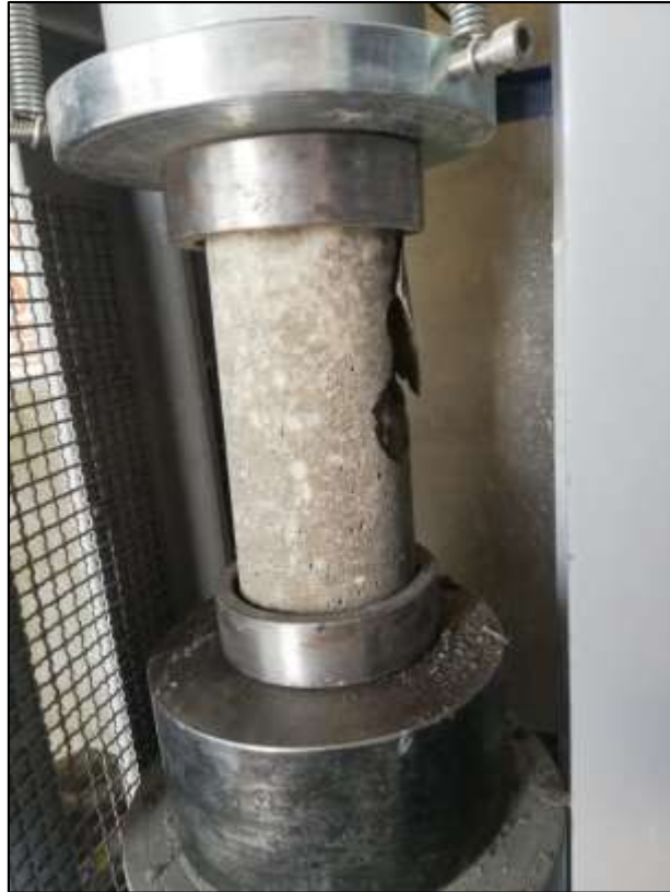
Figura 37. Rotura de probeta de concreto
