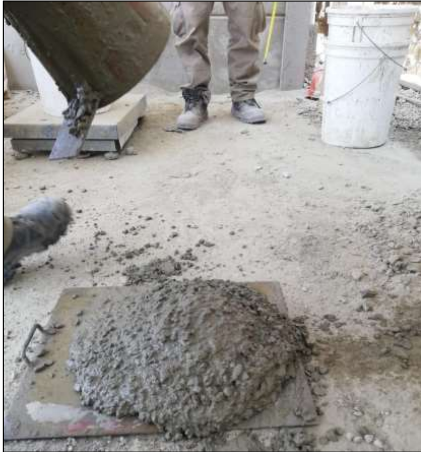
Figura 45. Asentamiento de concreto fresco
