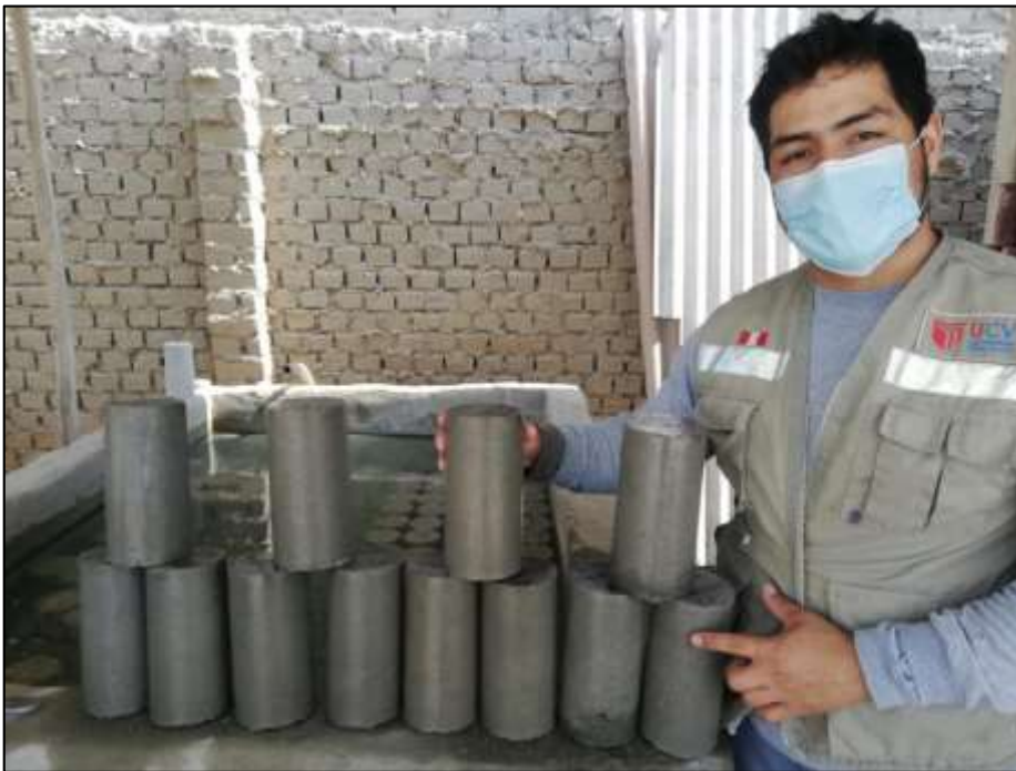
Figura 20. Retiro de probetas de poza de curado.
