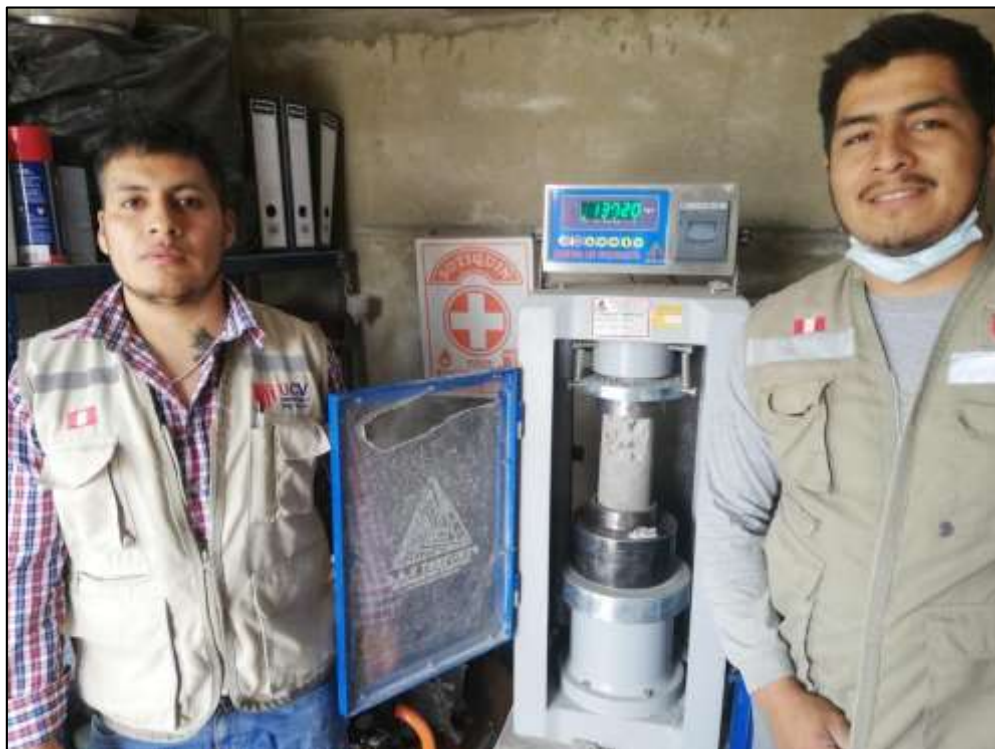
Figura 32. Prensa Hidráulica de probetas de concreto
