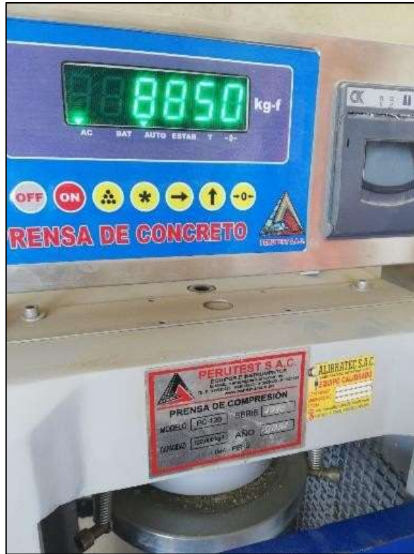
Figura 21. Resistencia a la compresión de probetas a 3 días
