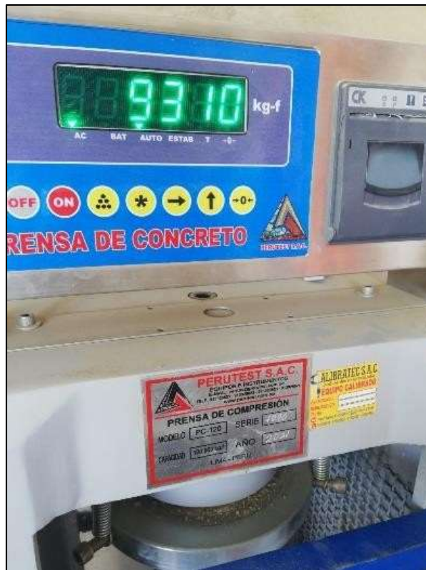
Figura 22. Resistencia a la compresión de probetas a 3 días 2
