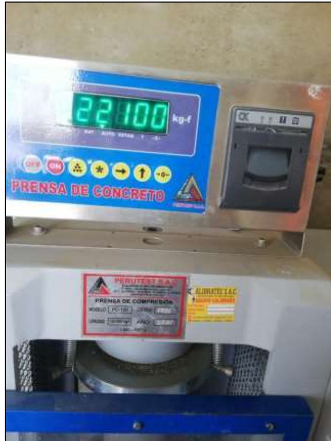
Figura 43. Resistencia a la compresión de probeta a 28 días
