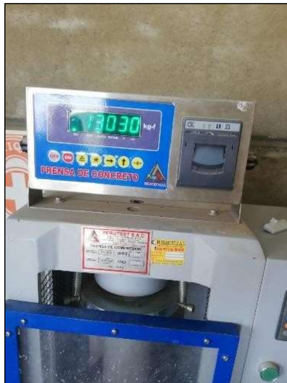
Figura 33. Resistencia a la compresión a 28 días
