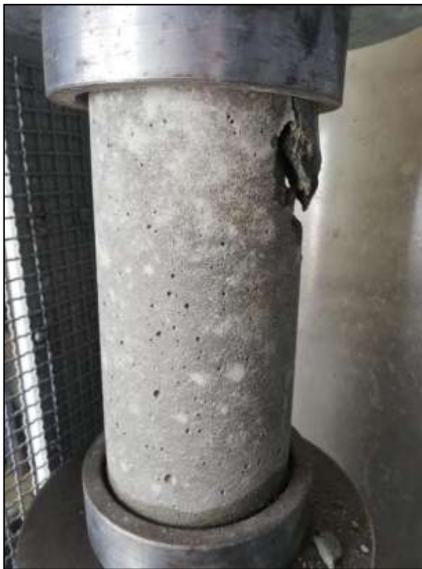
Figura 38. Rotura de probeta de concreto 2
