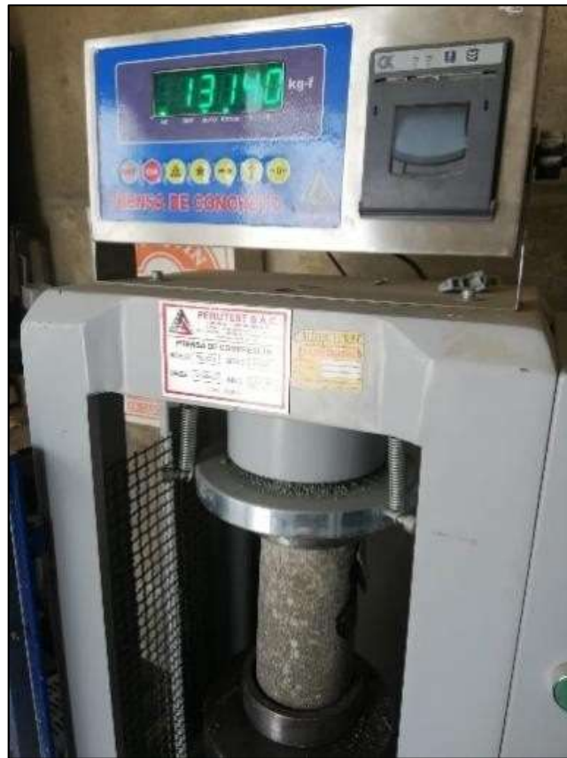
Figura 35. Resistencia a la compresion a 7 dias 2
