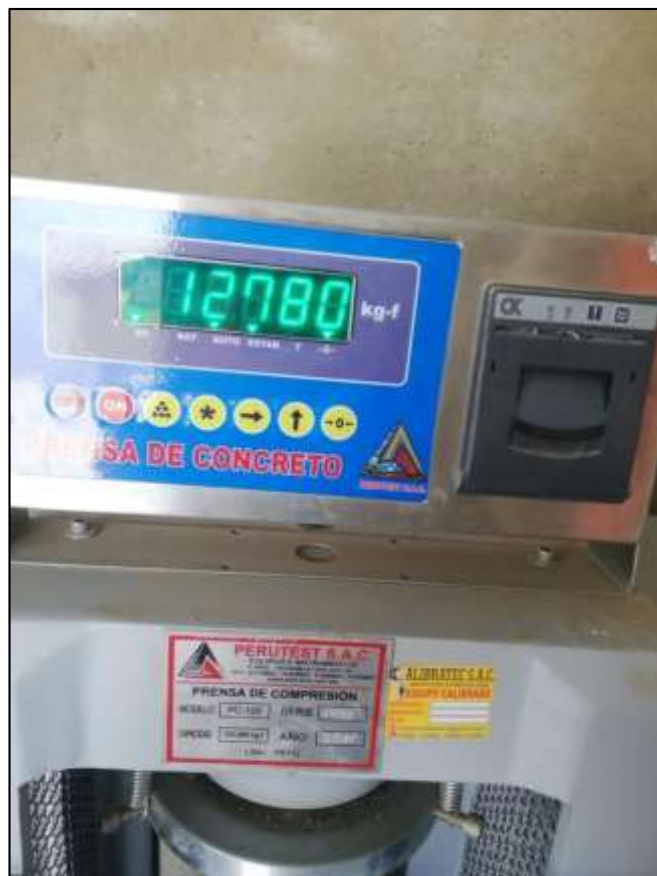
Figura 40. Rotura de probeta de concreto a 7 días
