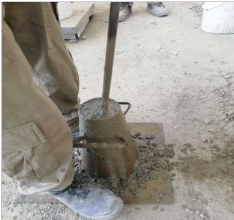
Figura 44. Ensayo de Slump
