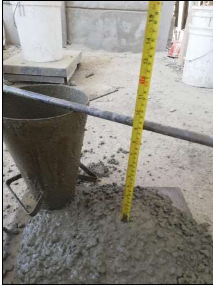
Figura 46. Medida de asentamiento para concreto fresco.
