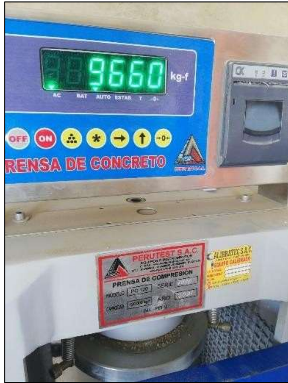
Figura 23. Resistencia a la compresión de probetas a 3 días 3
