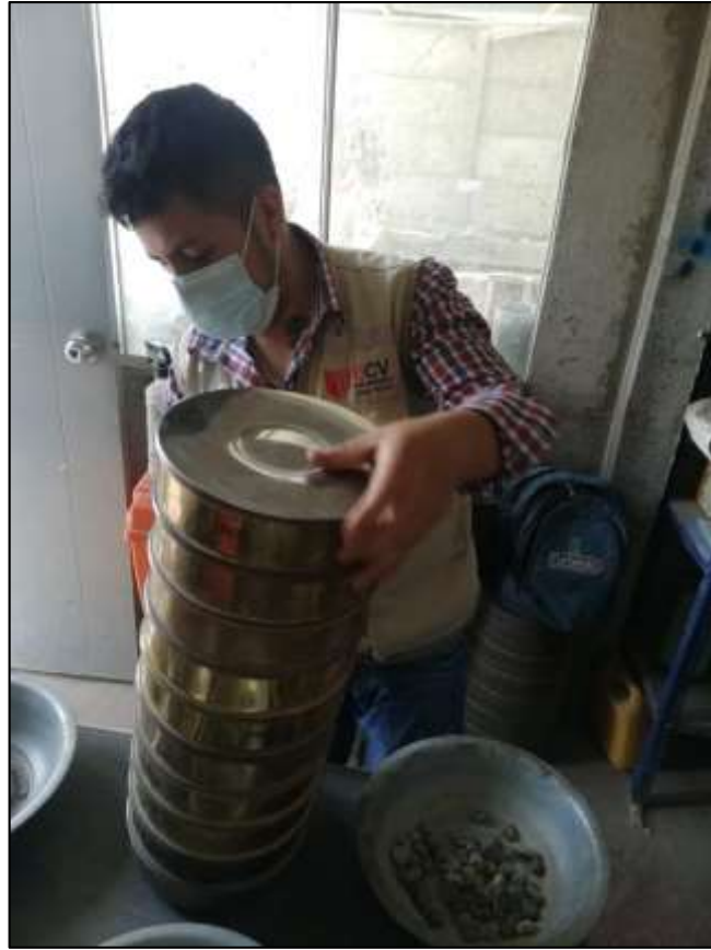
Figura 25. Tamizado de material grueso
