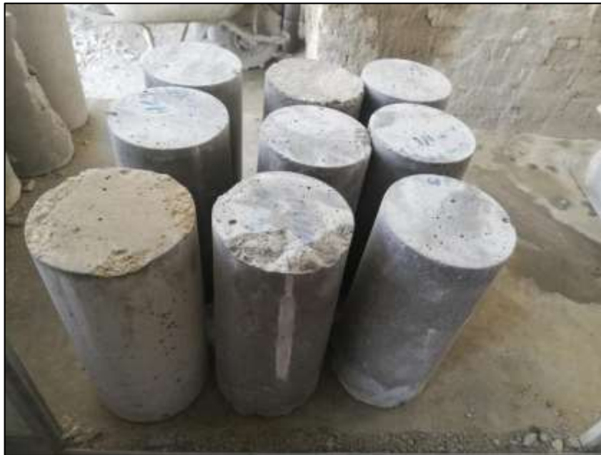
Figura 42. Probetas a 28 días listas para ensayo de rotura.
