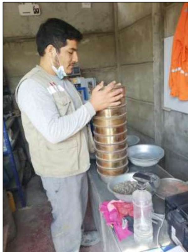
Figura 26. Tamizado de material
