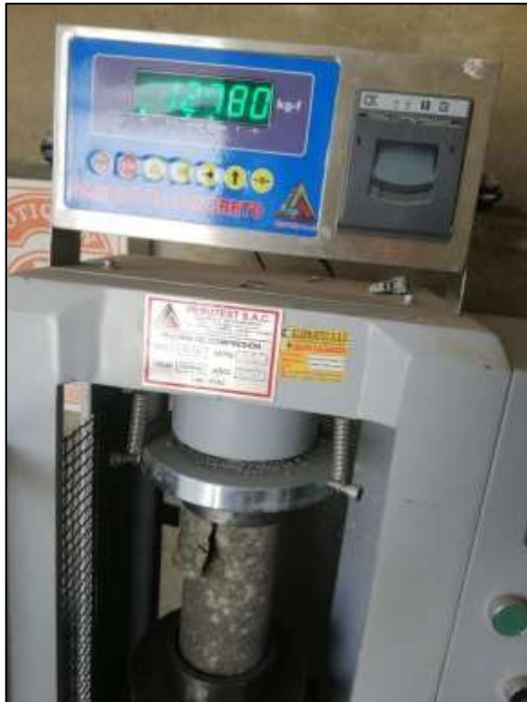
Figura 39. Rotura de probeta de concreto a 7 días
