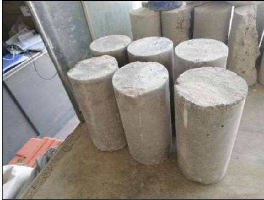
Figura 41. Probetas listas para ensayo de rotura
