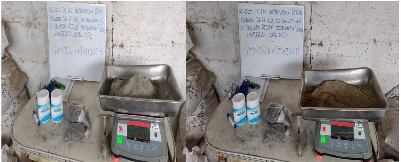
Figura 35: Peso del cemento y arena para el diseño de mezcla. Fuente: elaboración propia
