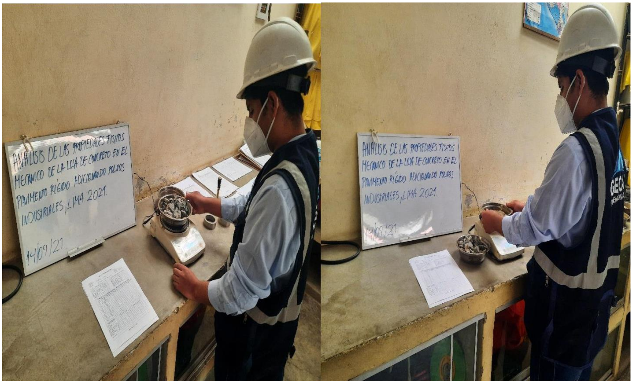
Figura 26: Peso seco de la arena y la grava Fuente: elaboración propia
