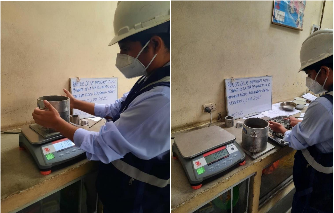
Figura 30: Peso del recipiente vacío y agregado de grava Fuente: elaboración propia
