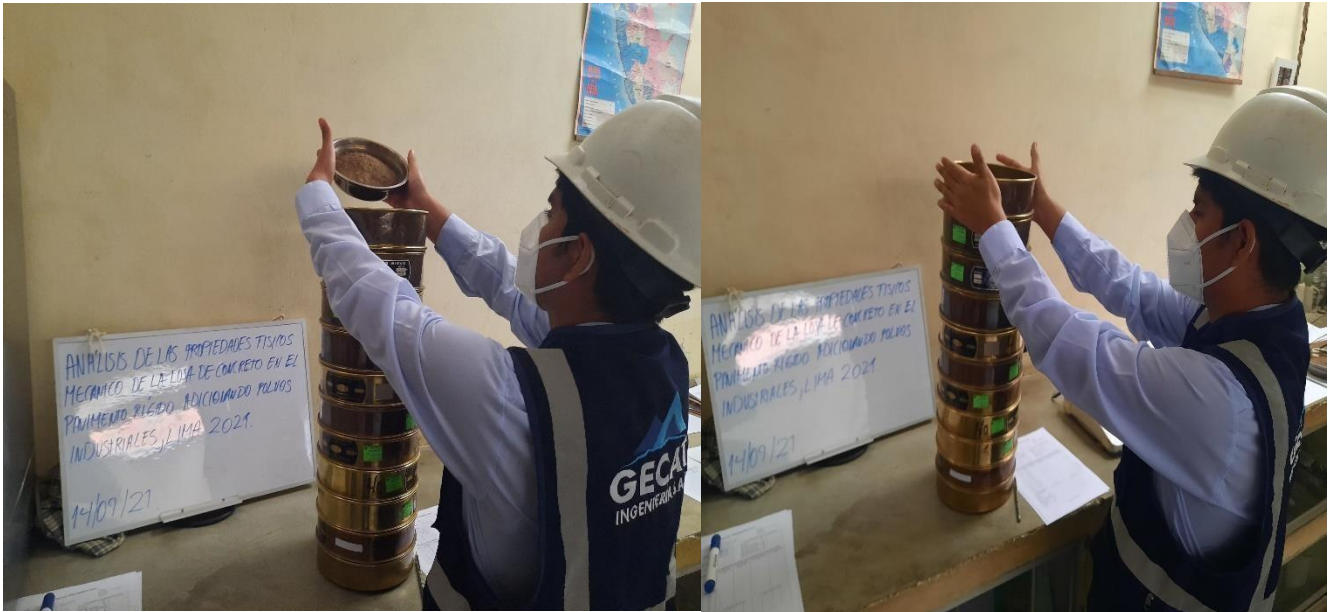
Figura 27: vaciado de agregados y zarandeo Fuente: elaboración propia
