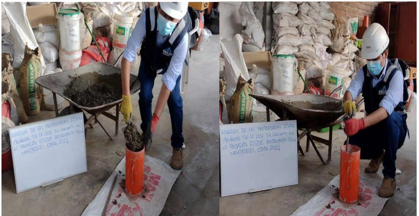
Figura 41: llenado de la mezcla y expulsión de aire. Fuente: elaboración propia
