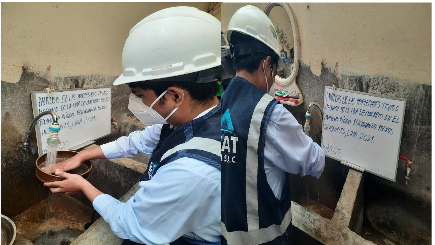
Figura 28: lavado de impurezas de los finos Fuente: elaboración propia
