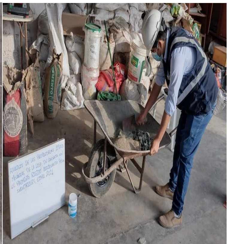
Figura 39: Diseño de mezcla al 30%LM+4%CM y Preparación del diseño de mezcla. Fuente: elaboración propia
