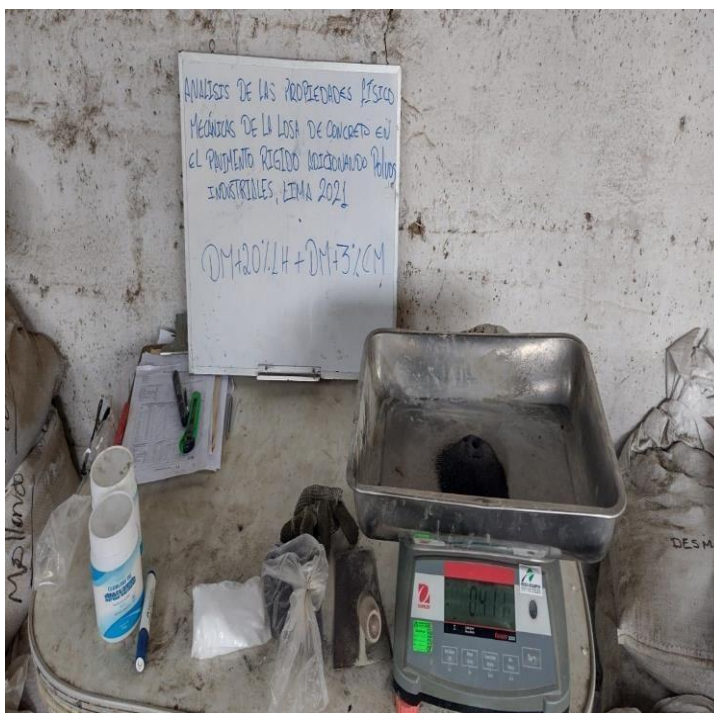
Figura 37: Peso de los polvos industriales limaduras de hierro y cloruro de magnesio. Fuente: elaboración propia
