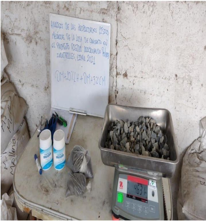
Figura 36: Peso del piedra y agua para el diseño de mezcla. Fuente: elaboración propia
