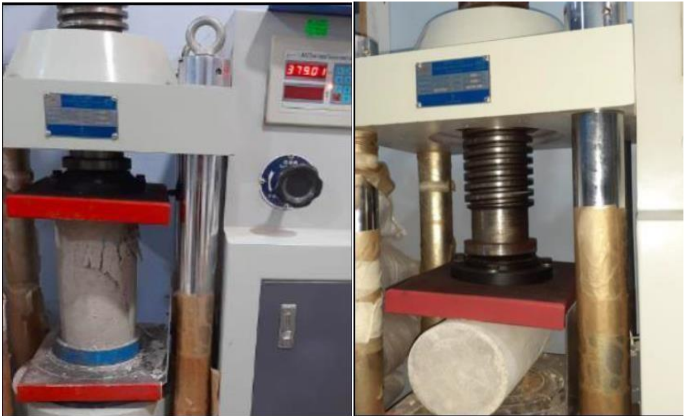
Figura 43: ensayo compresión y rotura diametral. Fuente: elaboración propia
