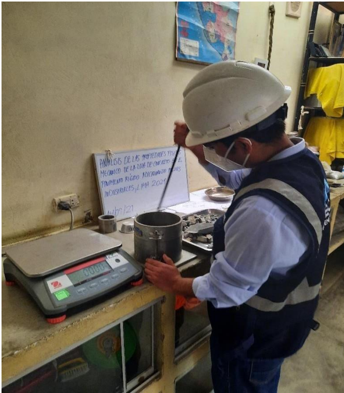
Figura 31: Peso unitario y vacíos en agregados Fuente: elaboración propia
