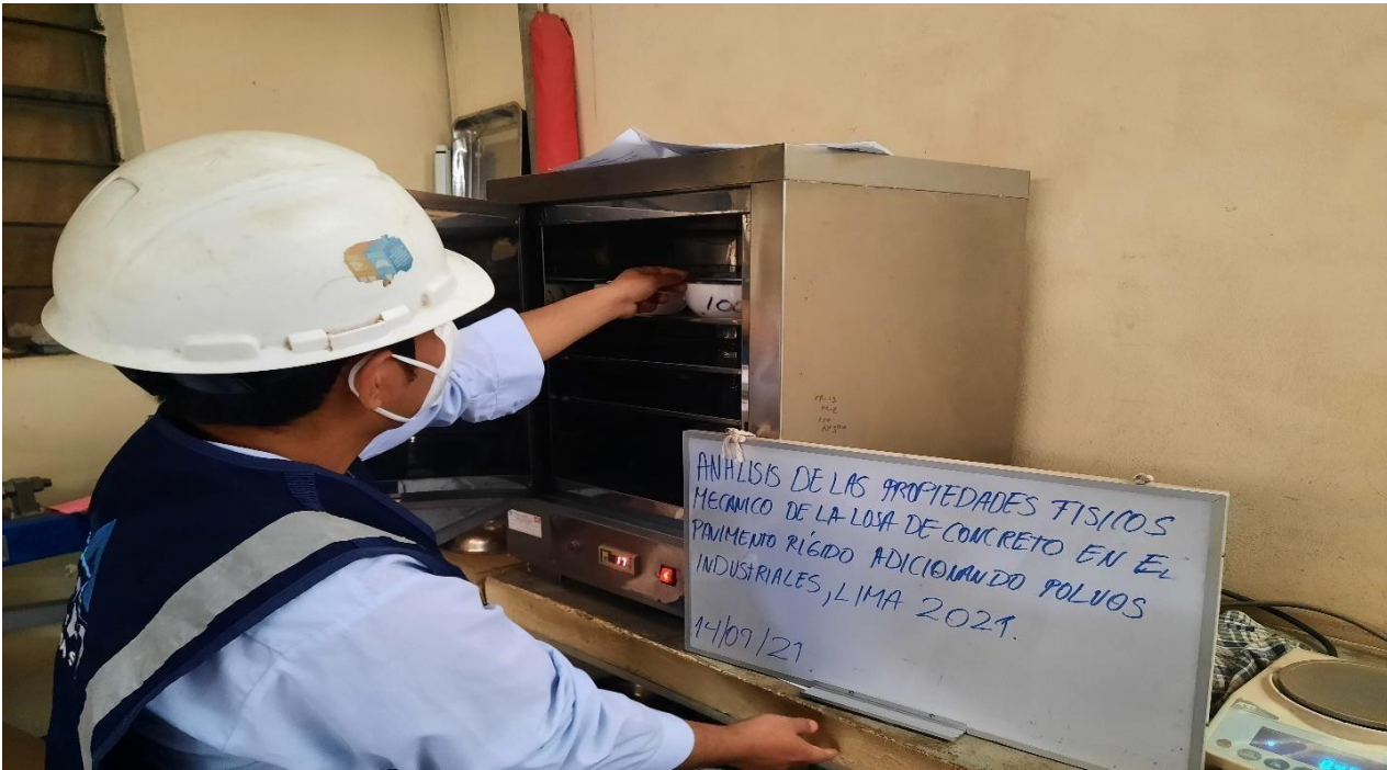
Figura 29: secado de los finos al horno Fuente: elaboración propia
