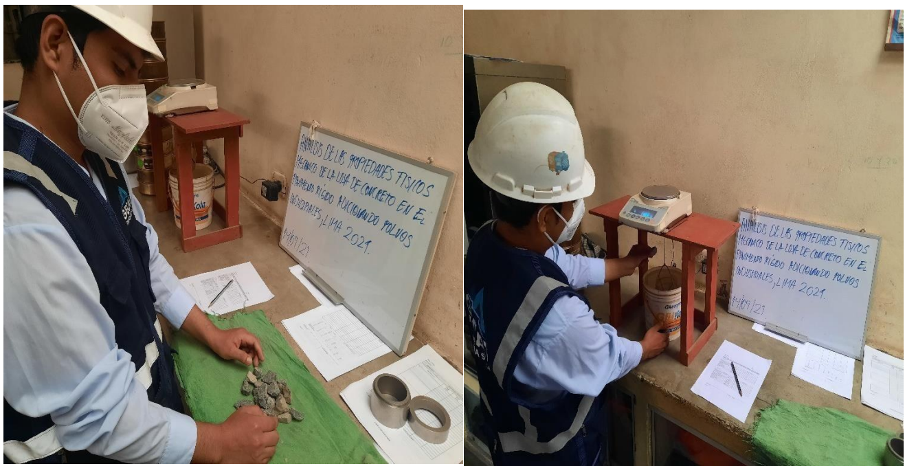
Figura 33: Clasificación de partículas chatas, peso específico y absorción. Fuente: elaboración propia
