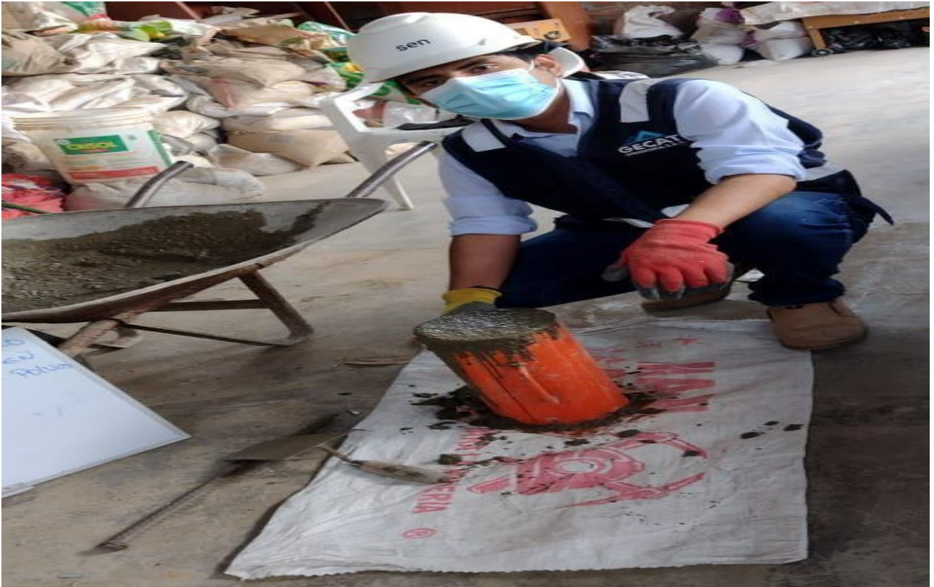
Figura 42: llenado completo del diseño de mezcla. Fuente: elaboración propia
