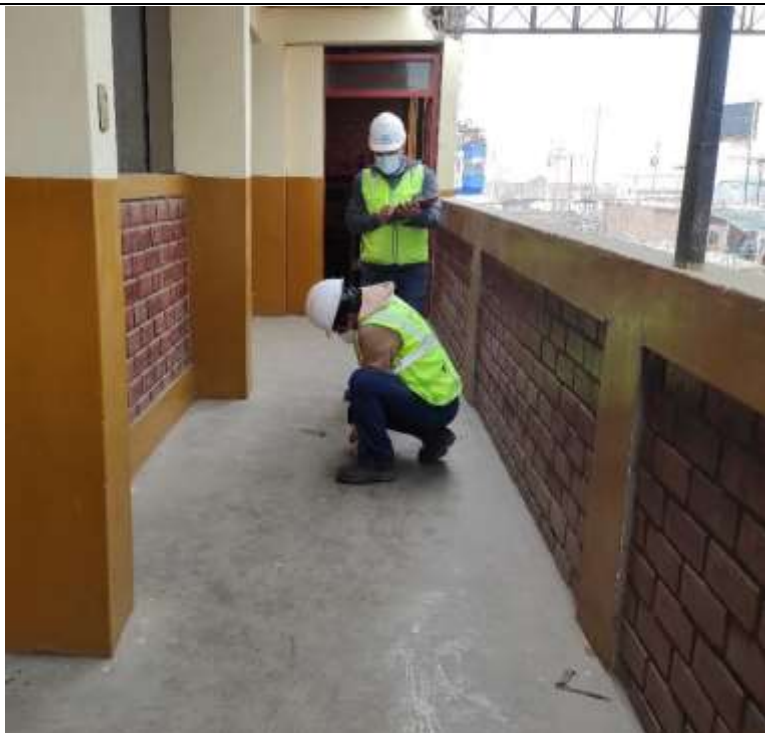
Fotografía 5. Ensayo de esclerometria C-2
