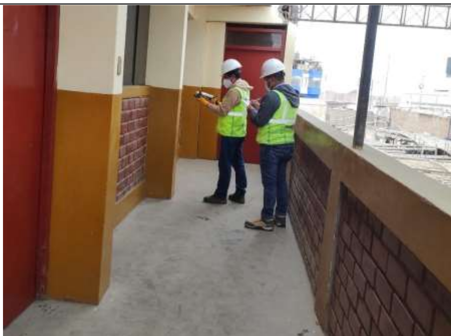
Fotografía 2. Ensayo de esclerometria en C-7
