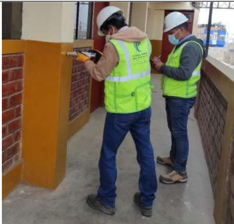
Fotografía 4. Ensayo de esclerometria en C-6
