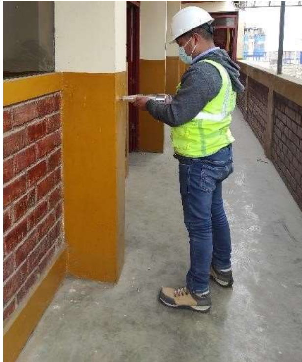
Fotografía 9. Ensayo de esclerometría C-4
