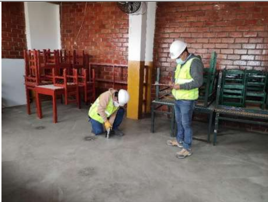
Fotografía 9. Ensayo de esclerometría C-4
