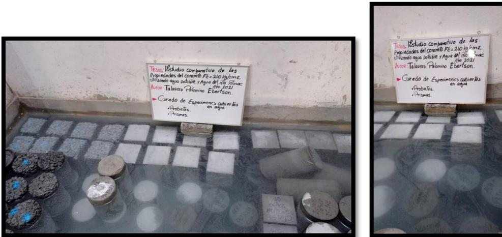
Fotografía 4: Probetas sumergidos
