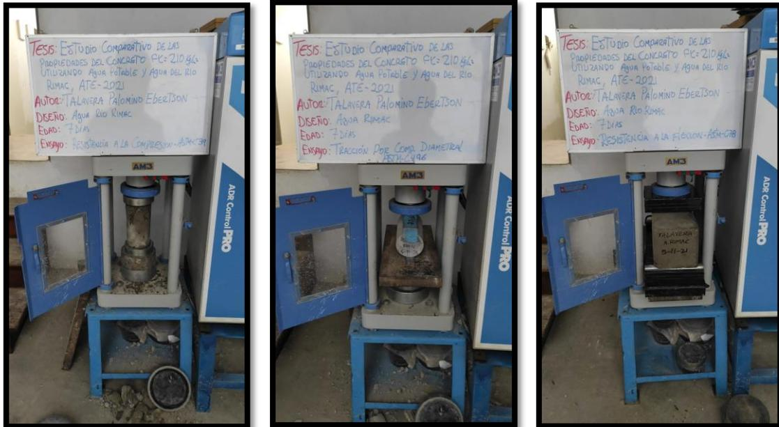
**Fotografía 5:** Probetas en estado endurecido para rotura a la compresión, tracción y flexión del concreto.
