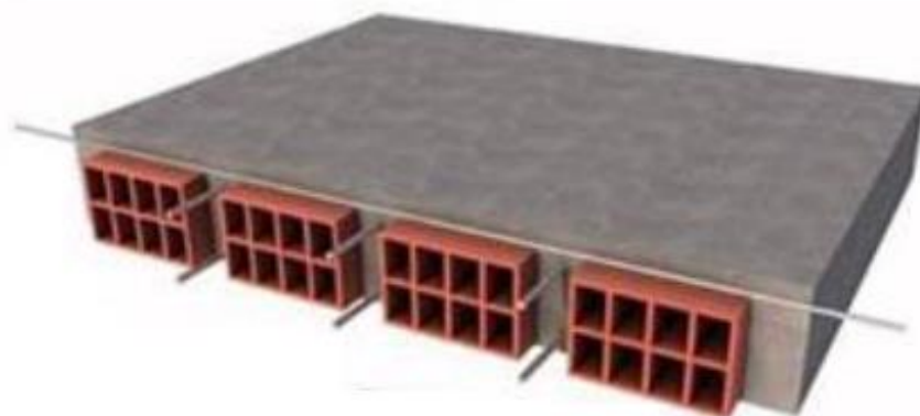
Figura 18 Losa aligerada unidireccional
