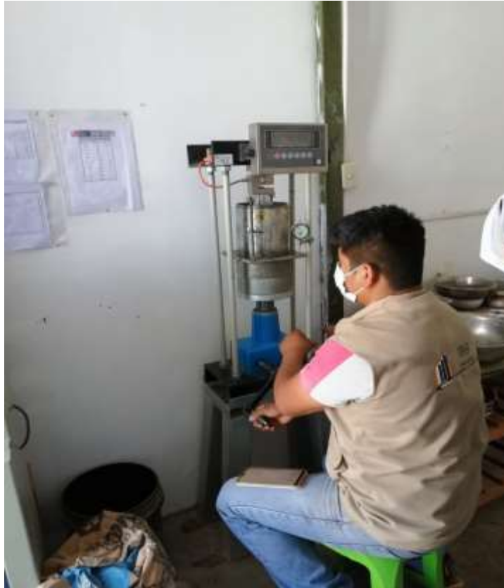
Fotografía 78: Ensayo de la muestra en la Prensa de Carga Mecánica de CBR digital
