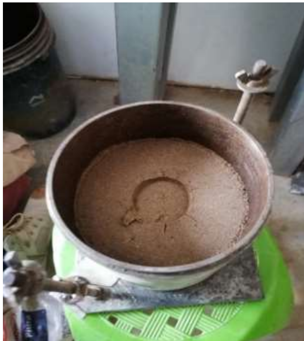
Fotografía 79: Resultado del Ensayo de la muestra en la Prensa de Carga Mecánica de CBR digital.
