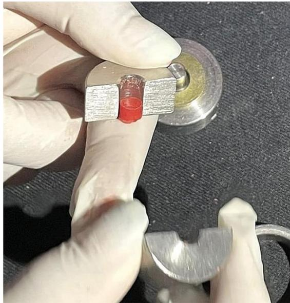
Retiro del disco de resina acrílica Duralay, posterior a su polimerización
