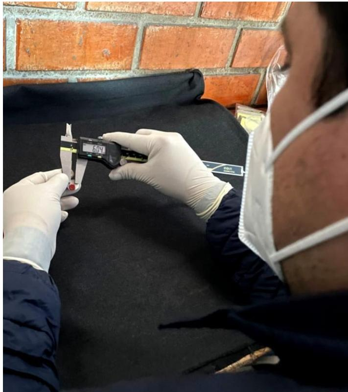
Ingeniero realizando las mediciones de los discos con el Vernier Digital.
