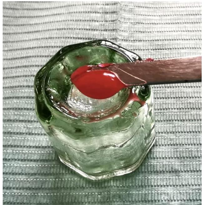
Textura final de la mezcla de resina acrílica Pattern Resin
