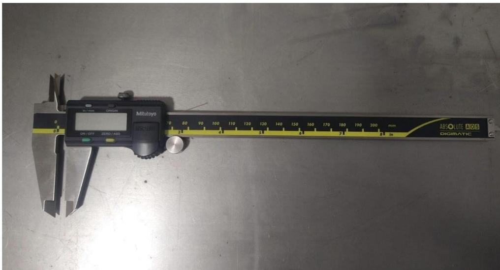
Calibrador o Vernier digital, marca Mitutoyo
