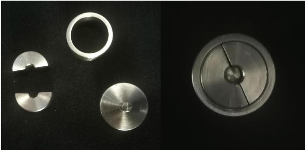
Se observa el patrón de acero de 6x4mm utilizado para la confección de los discos de resina acrílica de autocurado (ISO 4049)
