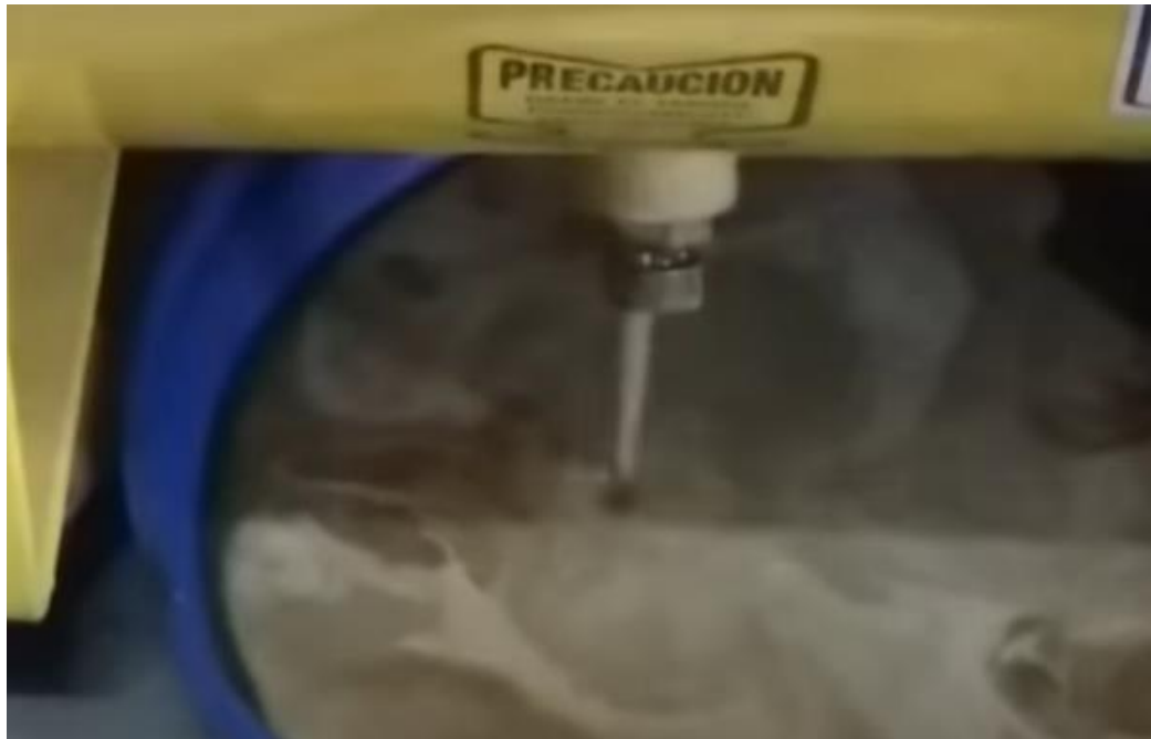
Figura 2: Agua condensada en el tanque
