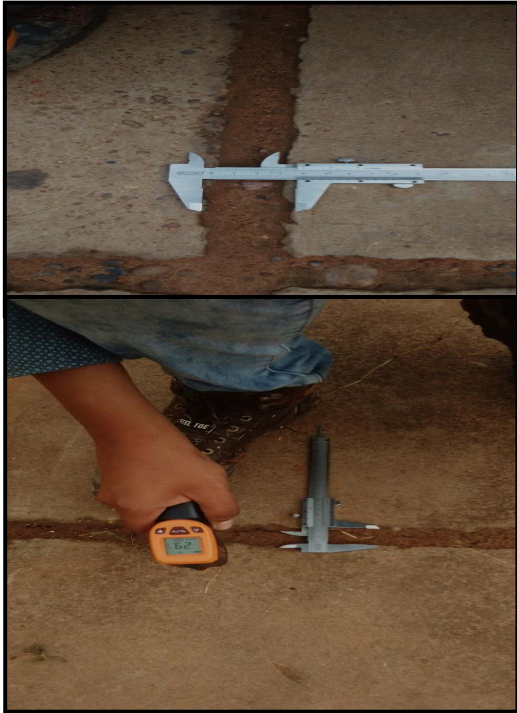
Figura N ° 10. recolección de datos junta transversal derecha primer tramo en la mañana
