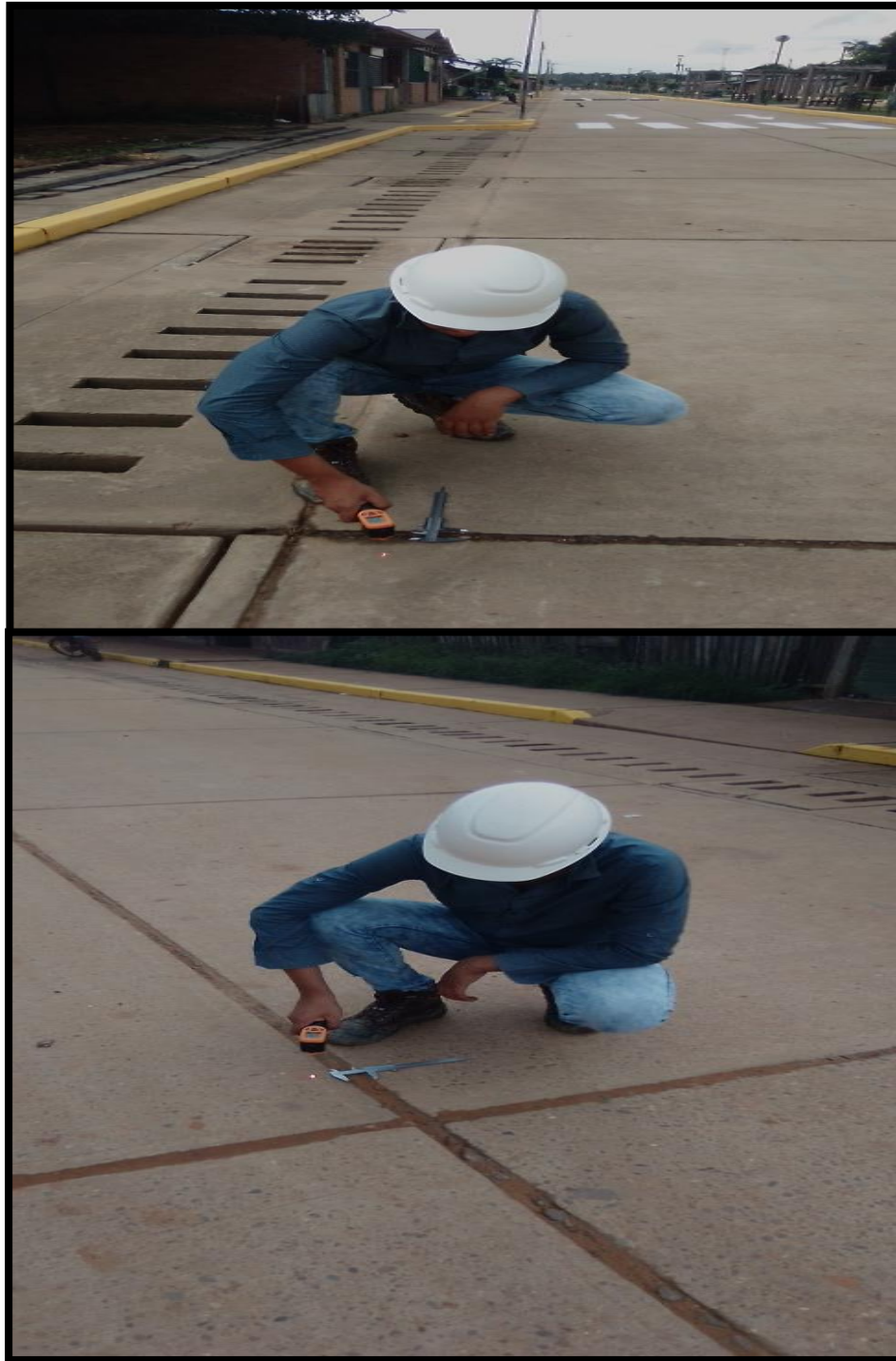
Figura N ° 13. recolección de datos junta transversal izquierda segundo tramo medio día
