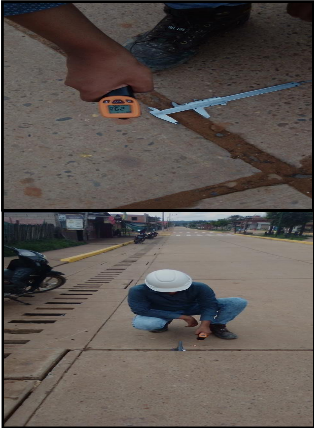
Figura N ° 09. recolección de datos junta transversal izquierda primer tramo en la mañana
