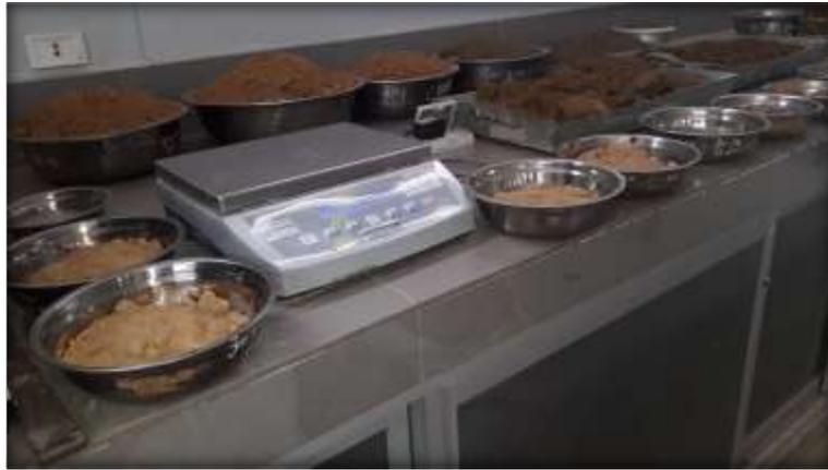
Muestra seca después de 24 horas en el horno.
