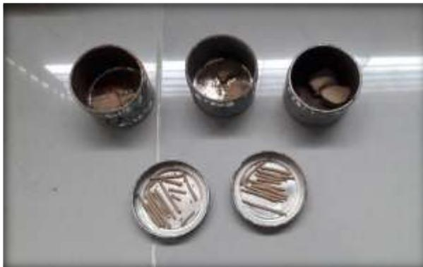
*Muestra seca después de 24 hrs en el horno.*
