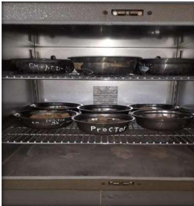
*Colocación de la Muestra lavada en el horno a una temperatura de 110° durante 24 horas*
