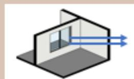
De acuerdo a lo analizado en la zonificación de la vivienda 7 tipo 02, se emplea el sistema de ventilación directa, ya que tiene ventanas a los extremos de los ambientes, el aire que ingresa por la fachada principal no se disipa por la ventana que conecta con el patio que vendría a ser la lavandería
