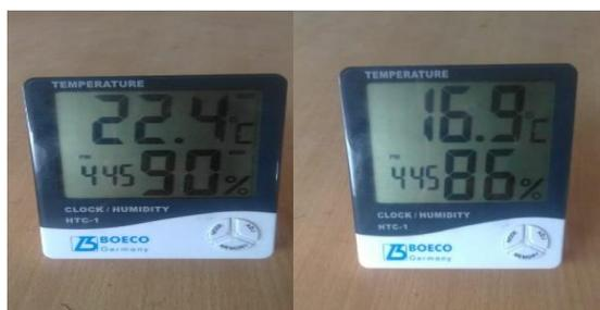
Figura 13: *Termohigrómetro digital*
