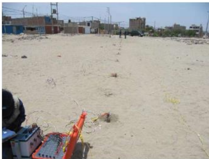
Figura 13: Disposición del equipo de prospección eléctrica para la toma de datos
