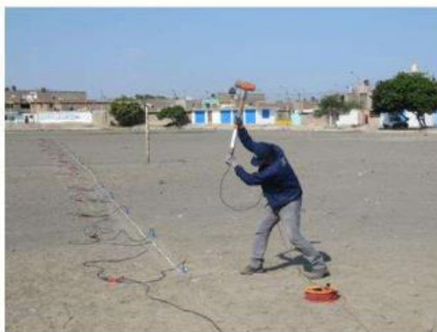
Figura 12: Disposición del equipo de refracción sísmica en la ciudad de Nuevo Chimbote
