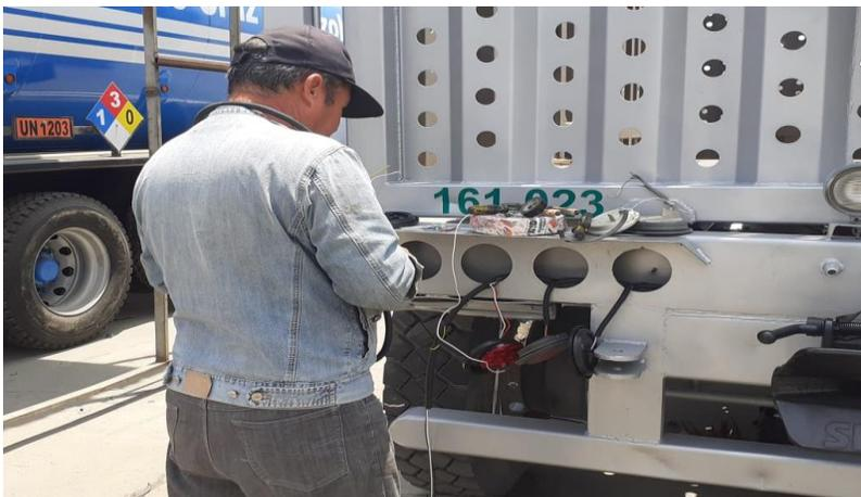
**Sistema de aire:** Es este proceso se hace el servicio respectivo en cuanto al sistema de frenos, se colocan soportes neumáticos, válvulas y mangueras para el aire. Este proceso lo desarrolla un técnico de mecánica automotriz. El tipo que se demora en esta operación es aproximadamente de cinco horas ya que para todas las unidades prácticamente es el mismo proceso, se utilizan taladros, amoladoras, manómetros.
