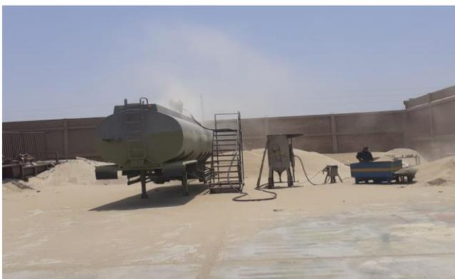
**Pintado:** Base zincromato. Se aplica una formula epóxica (jet para el interior y tekno para el exterior) de acuerdo con la corrosión que estará expuesta la unidad y requerimiento del cliente. El método que se utiliza es a presión, se utiliza compresoras para pulverizar la pintura.
