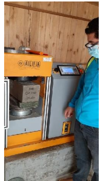
Ensayando la viga a Flexión
