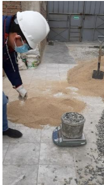
Peso unitario suelto del agregado
