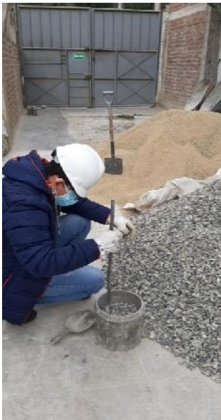
Peso unitario compactado del agregado
