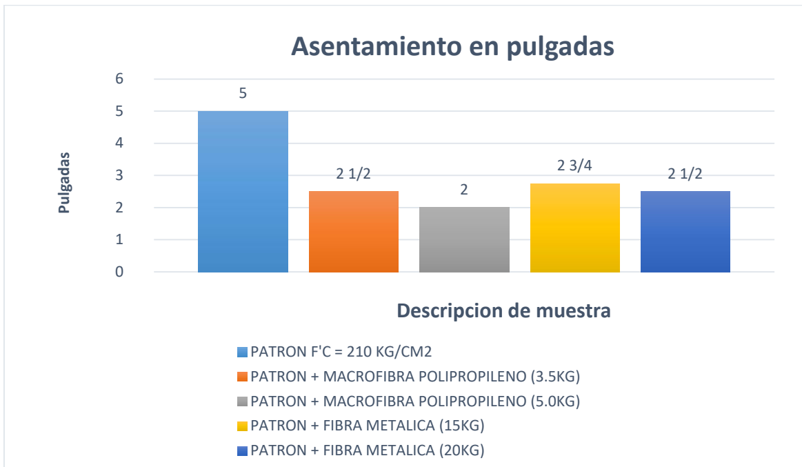
Figura 4. Asentamiento o Slump del concreto en estado fresco
