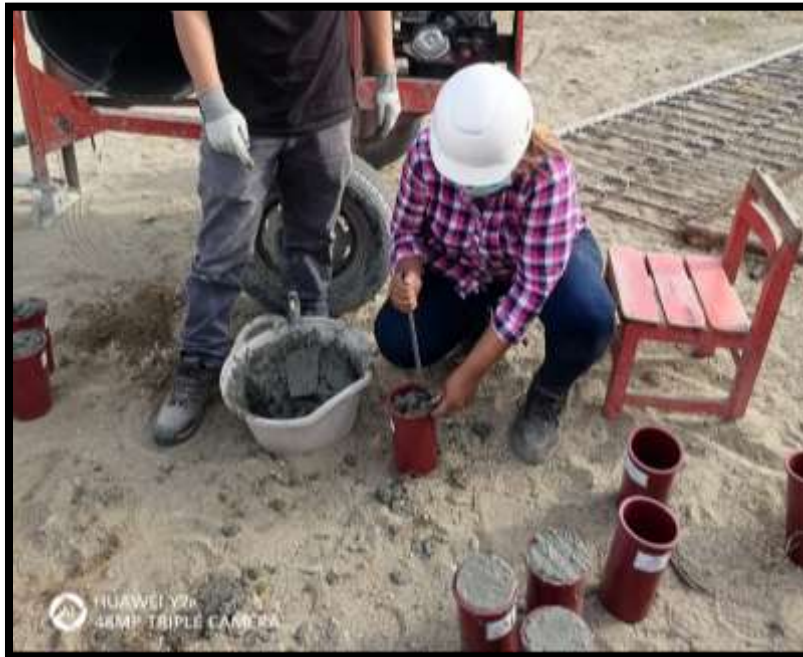
Figura 07: Se coloca la mezcla de concreto cada 3 capas dando 25 golpes
