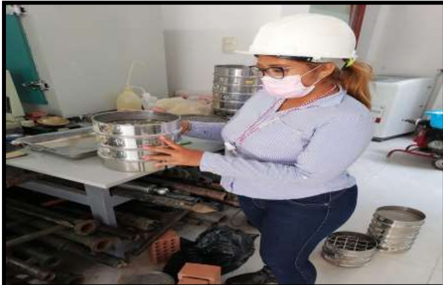
Figura 48: Se realiza el ensayo del tamizado
