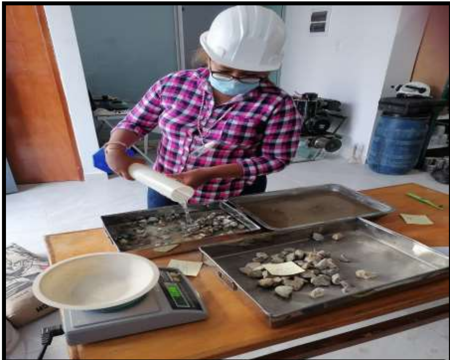
Figura 50: Absorción (cuanto absorbe de agua los agregados durante 24hrs)
