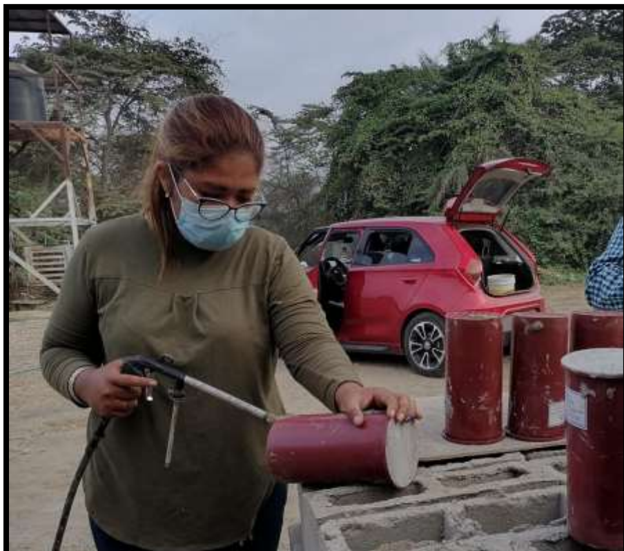
Figura 59: Se retira los testigos de concreto de los moldes
