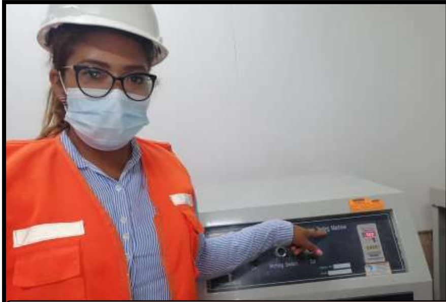
Figura 43: 500 revoluciones para el ensayo de abrasion
