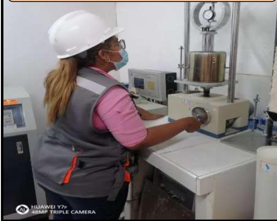
Figura 73: Compactación de la muestra para el Ensayo de CBR
