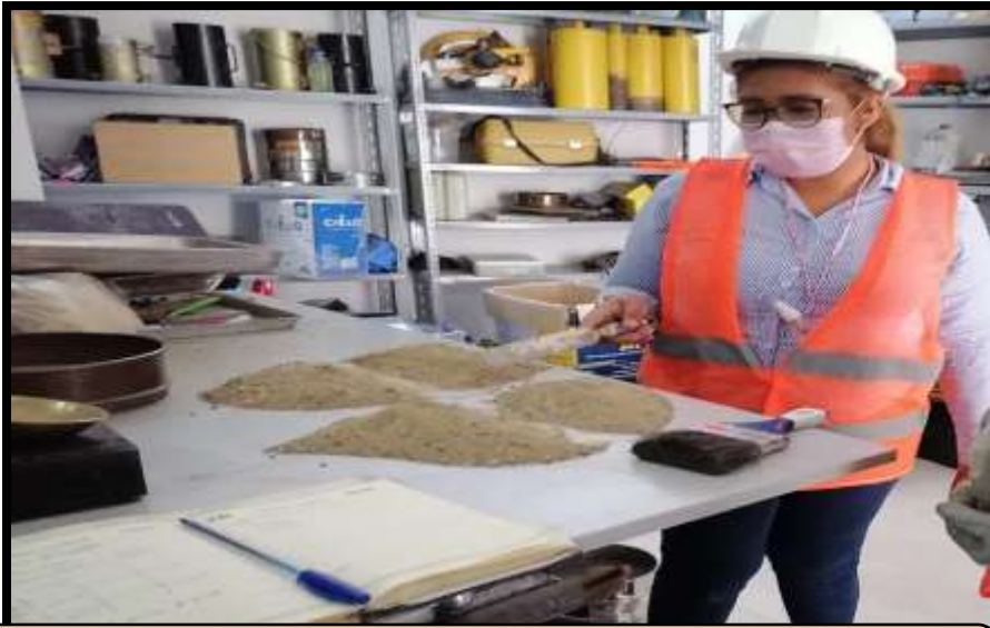
Imagen 46: Cuarteo del agregado fino para en ensayo granulométrico
