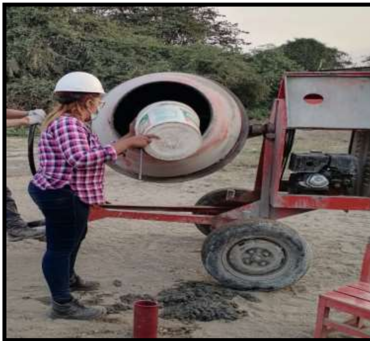
Figura 06: Se prepara la mezcla para las probetas.
