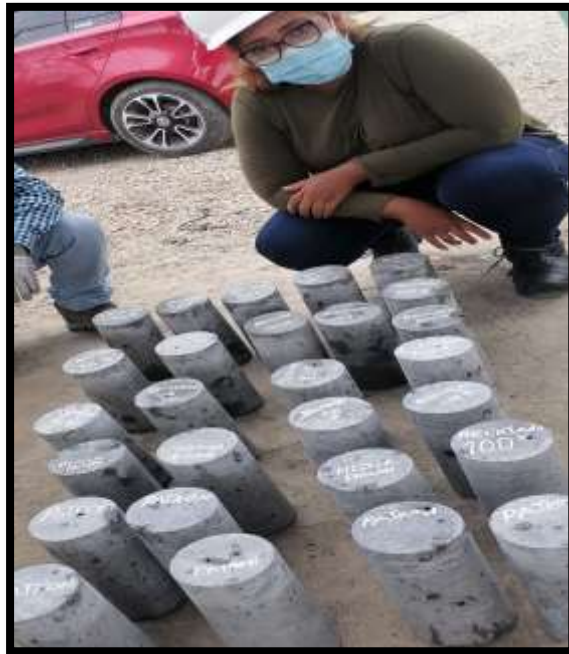
Figura 09: se realizaron 27 probetas, 9 probetas para cada diseño
