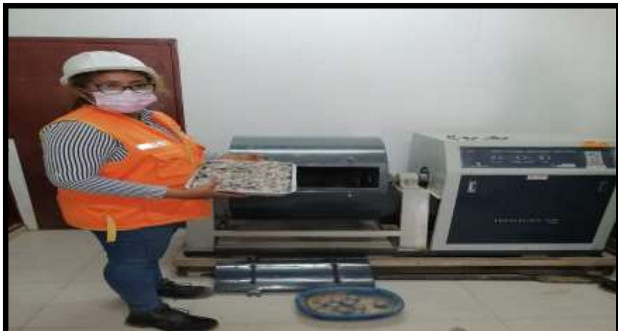
Figura 44: Abrasión con 12 esferas
