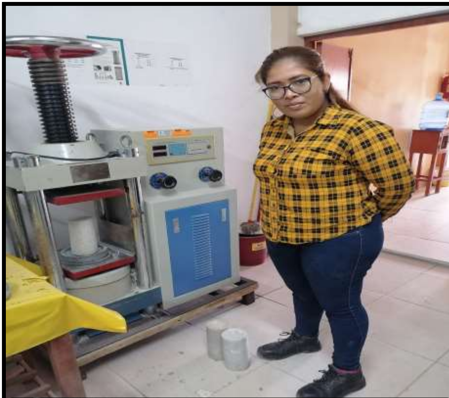
Figura 63: Rotura de probeta f'c : 210kg/cm 2
