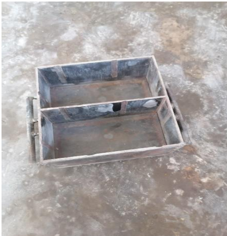
FOTO 08: Molde del adoquín con dimensiones 20cm x 10cm x 8cm.
