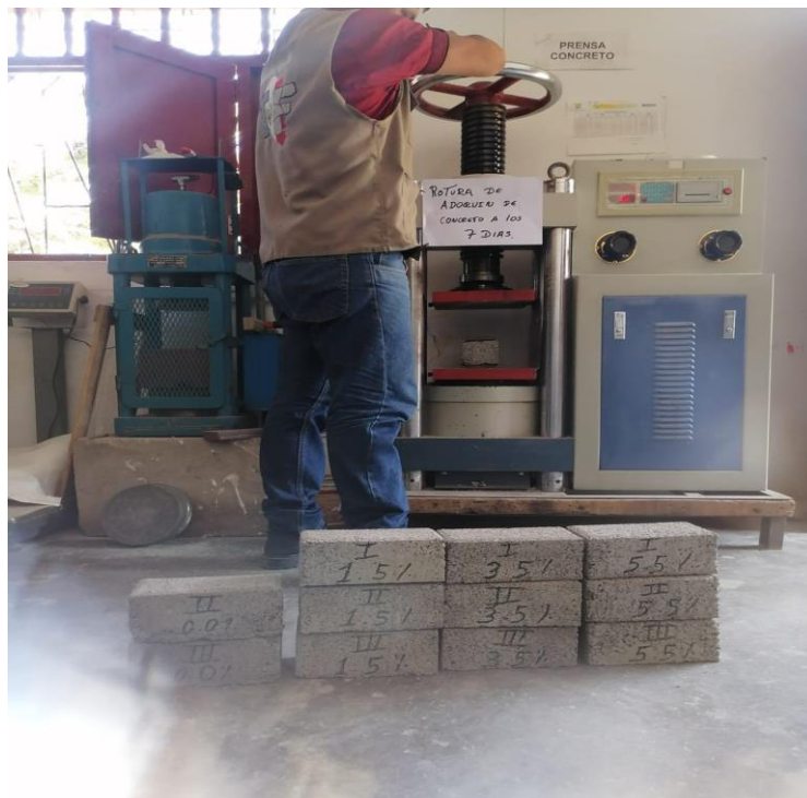
FOTO 10: Prueba de compresión f_c=175 \text{ kg/cm}^2 de los adoquines, con curado a los 7 días.
