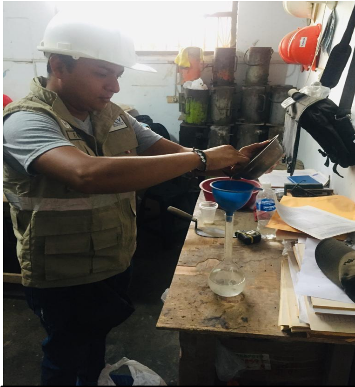
FOTO 03: Ensayo de peso específico y absorción del agregado fino (arena triturada).
