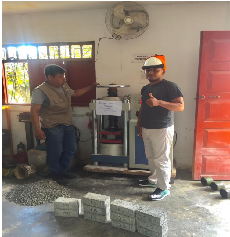
FOTO 11: Prueba de compresión f'c=175 \text{ kg/cm}^2 de los adoquines, con curado a los 14 días.
