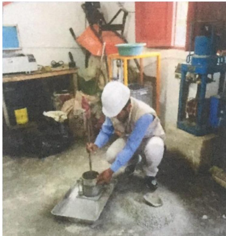
FOTO 06: Ensayo de peso unitario varillado del agregado fino.
