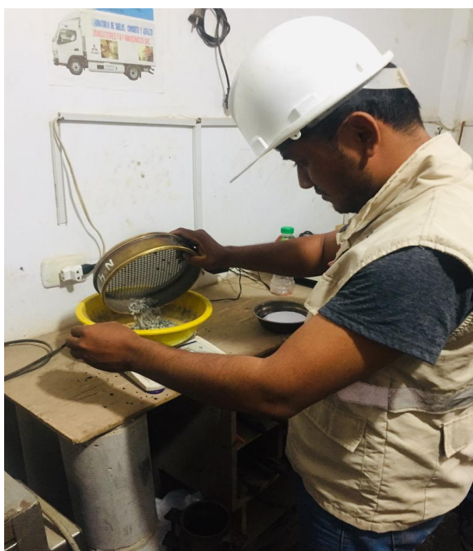
FOTO 02: Pesado del agregado retenido en el tamiz N° 4.
