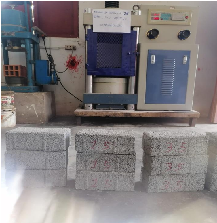
FOTO 12: Prueba de compresión f'c=175 \text{ kg/cm}^2 de los adoquines, con curado a los 28 días.
