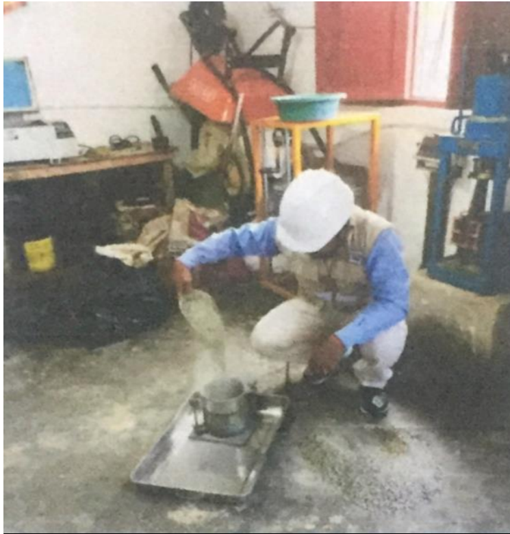
FOTO 05: Ensayo de peso unitario del agregado fino.
