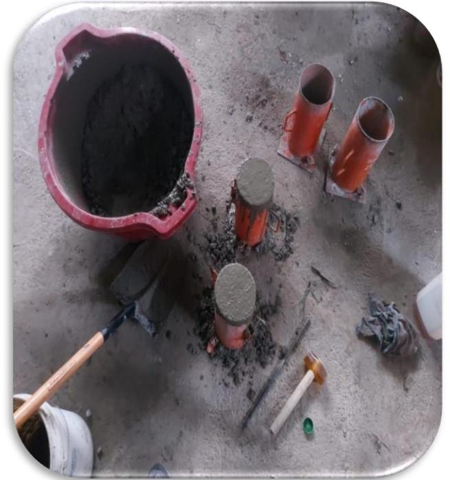
**Foto 14:** preparando la mezcla de concreto y encofrando con adicionando caucho y PET reciclado
