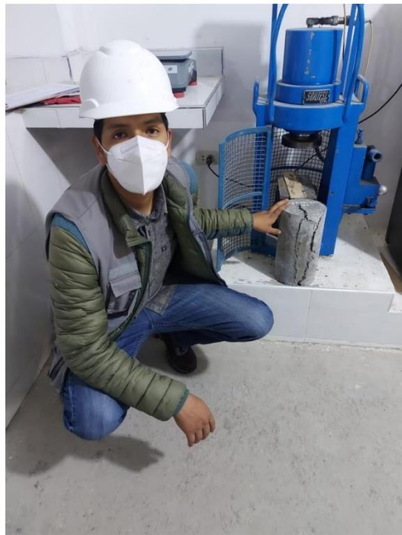
**Foto 16:** Rotura de probetas C.P y sustituyendo (ensayo tracción)
