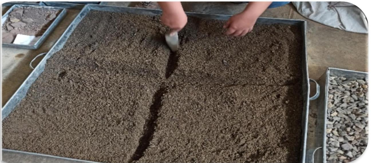
**Foto 6:** Cuarteo del Agregado Fino y Grueso para realizar el ensayo de contenido de humedad.
