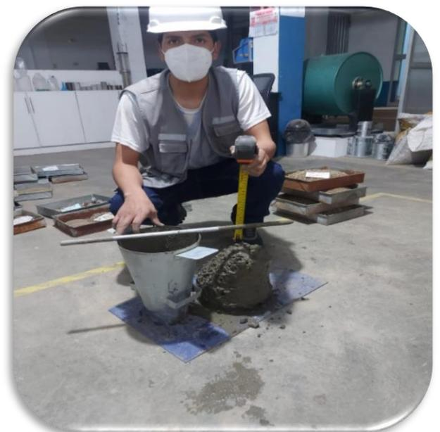
**Foto 10:** procedo a medir determinando el asentamiento para el concreto
