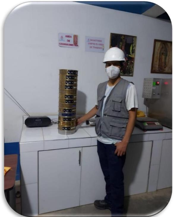
**Foto 8:** Tamizado de los agregados
