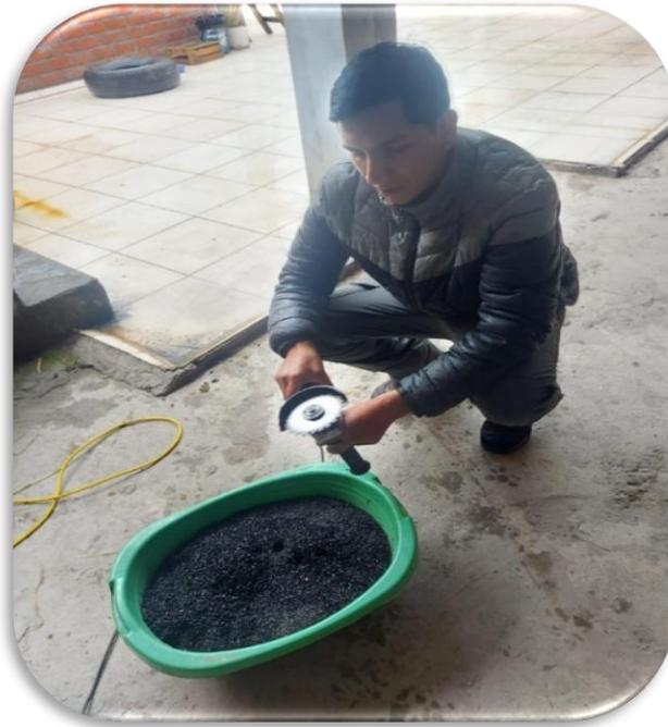
**Foto 3:** trituración del caucho con amoladora
