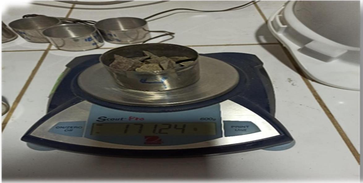
**Foto 7:** Agregado Fino y la piedra chancada para posteriormente colocarlo en el horno
