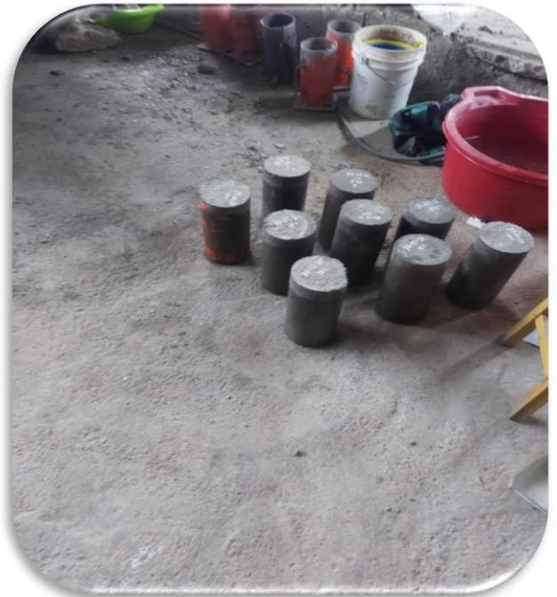
**Foto 12:** moldeo del concreto y desencofrado
