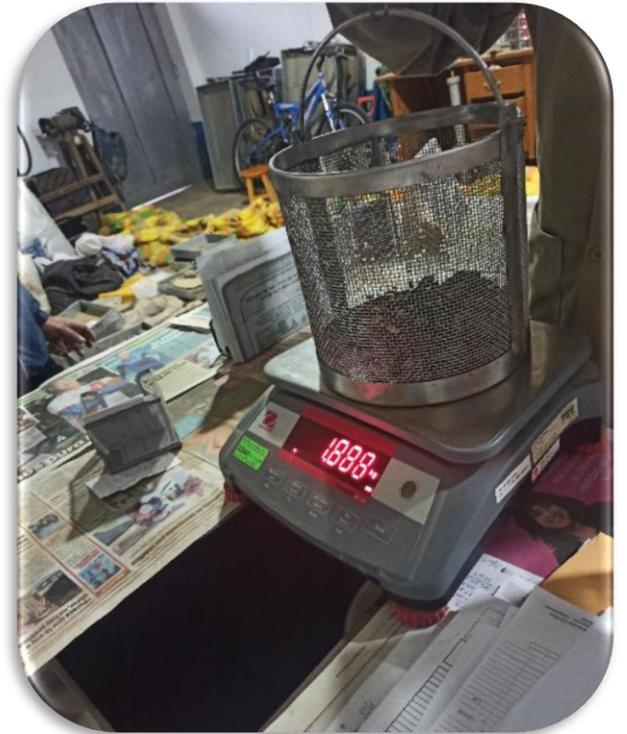
**Foto 9:** Ensayo de Absorción del Agregado Fino y grueso
