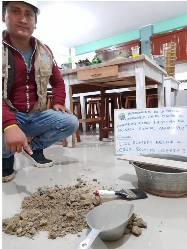
Una vez definida la cantidad de muestra se usan tamices unidos en una columna en orden descendente. En el tamiz más grueso se echa la muestra, y se somete a movimientos de rotación y vibratorios, una vez terminado con ese proceso se retiran los tamices y se pesa la muestra retenida en cada uno por separado.
