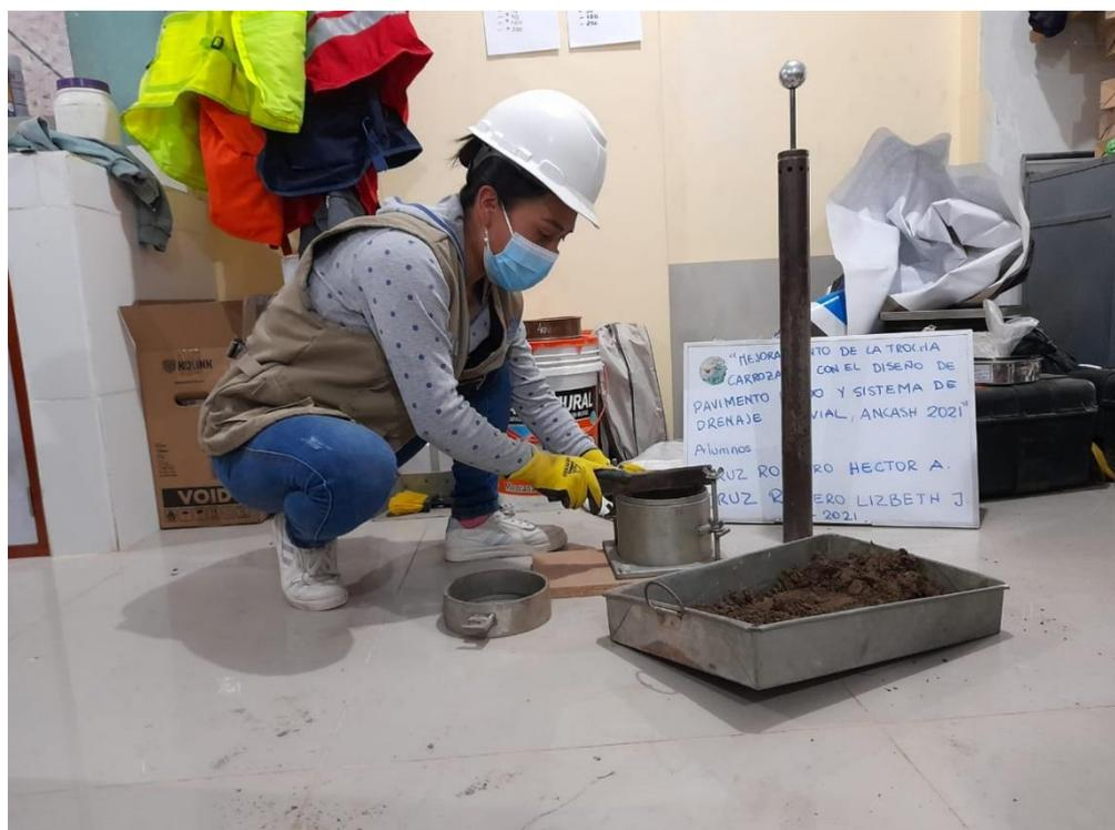
Acto seguido se enraza el molde, se desmonta y se vuelve a montar de manera invertida. Se colocan las placas perforadas y el vástago, así como los pesos que se requieren para determinar la sobrecarga. Se coloca el trípode de medida sobre el molde, de manera que coincida con el vástago del micro comparador. Luego, se deben tomar medidas diarias del micro comparador.
