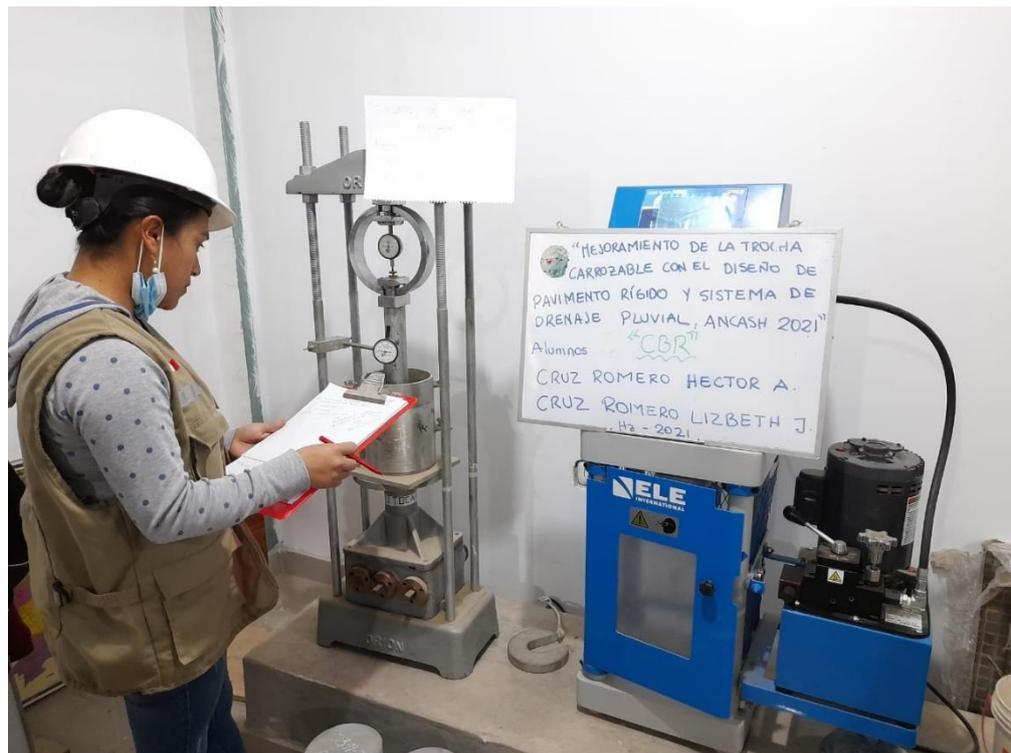
Posteriormente, se aplica la carga sobre el pistón de penetración a través de la prensa CBR y se toman las lecturas de la curva presión penetración.
