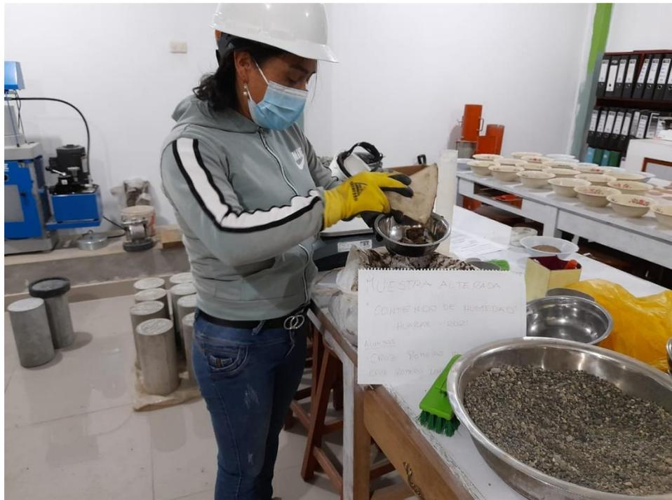
Para el contenido de humedad se procede a tomar la muestra del suelo y pesarla antes y después de su secado para calcular su contenido de humedad. La muestra esta sea cuando su peso es constante a una temperatura de 150 °C.
