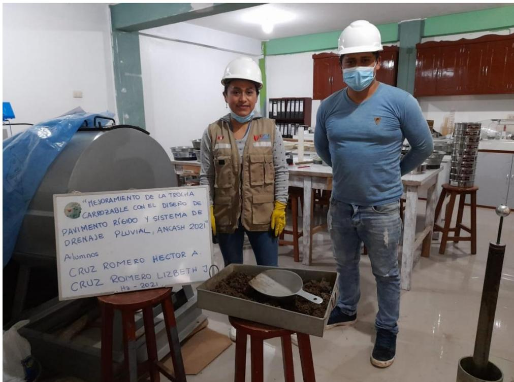
Seguidamente, se compacta la muestra en tres moldes CBR estandarizados de 15.24cm de diámetro y 17.78cm de altura. La muestra se compacta en 3 capas por molde, usando la energía de compactación de 15, 30 o 60 golpes por capa mediante una maza de 2.5 kilogramos que cae libremente de una altura de 305 mm.
