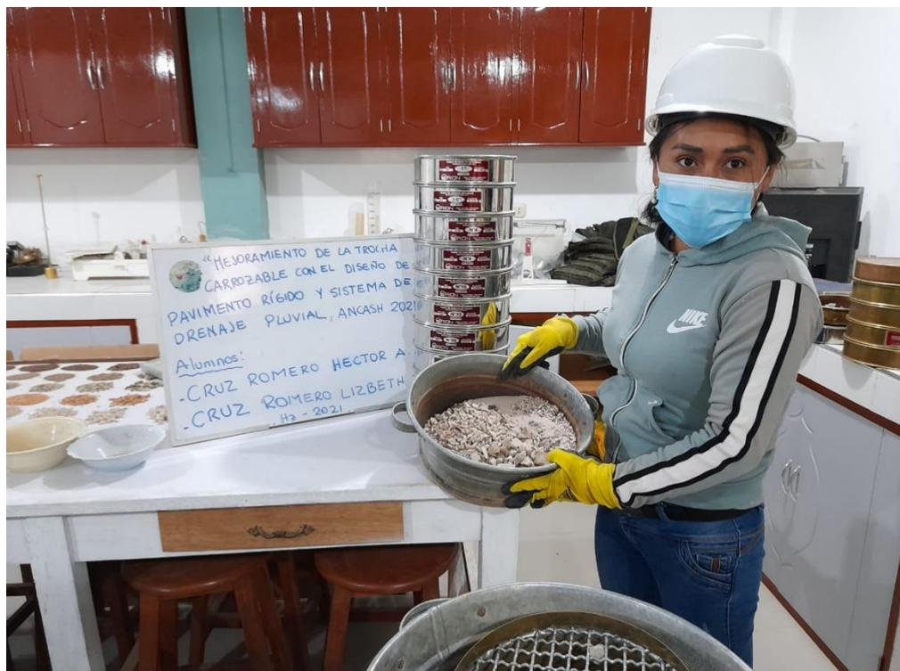
Posteriormente se realiza el cuarteo de las muestras, con la finalidad de contar con porciones representativas de tamaño adecuado y poder realizar las pruebas requeridas.
