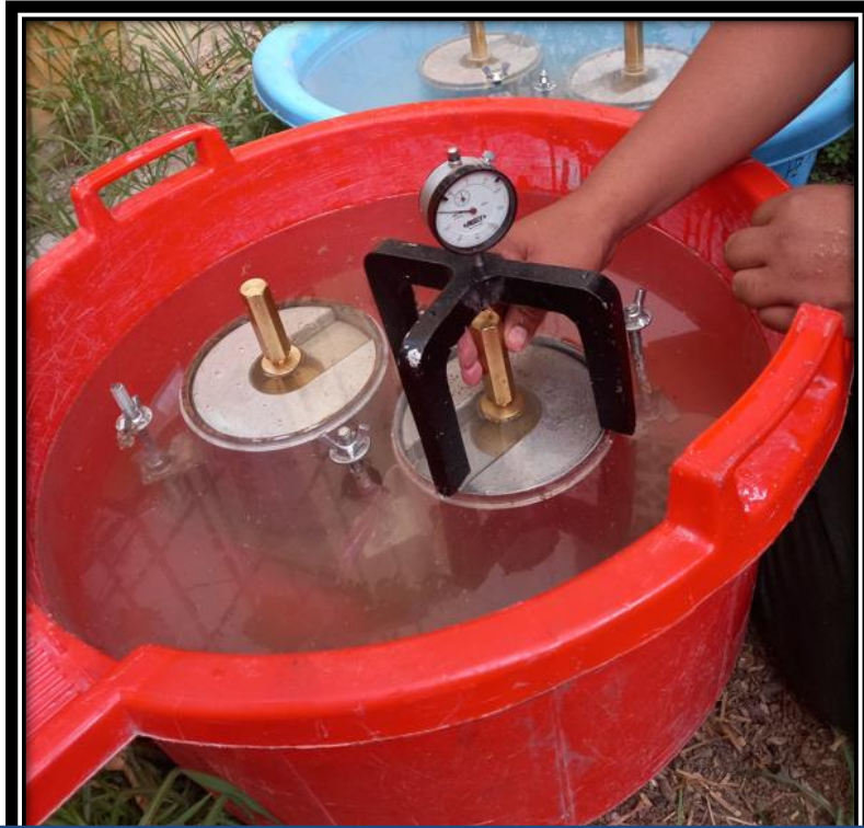
Figura 50: Medición de expansión a las 96 horas (4 días).
