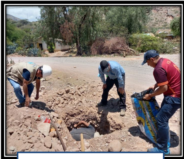
Figura 15: Extrayendo muestras de Calicata C-1.
