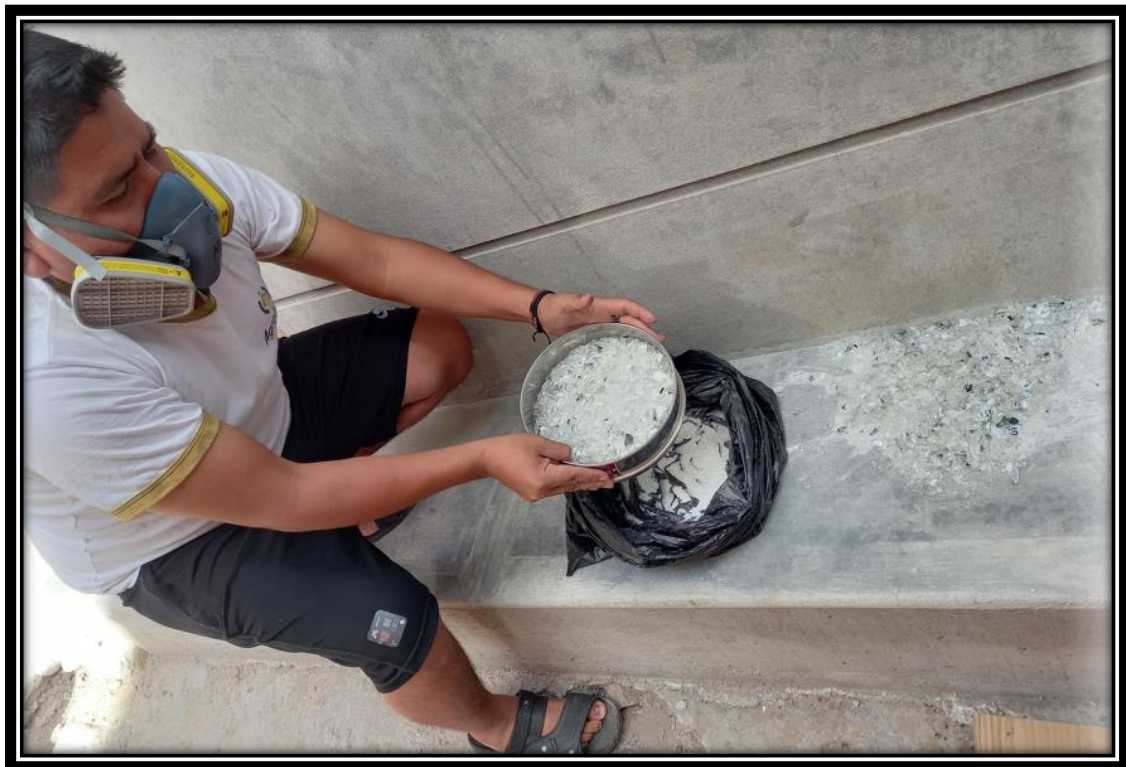
Figura 26: Tamizado de botella triturado con el tamiz #10.
