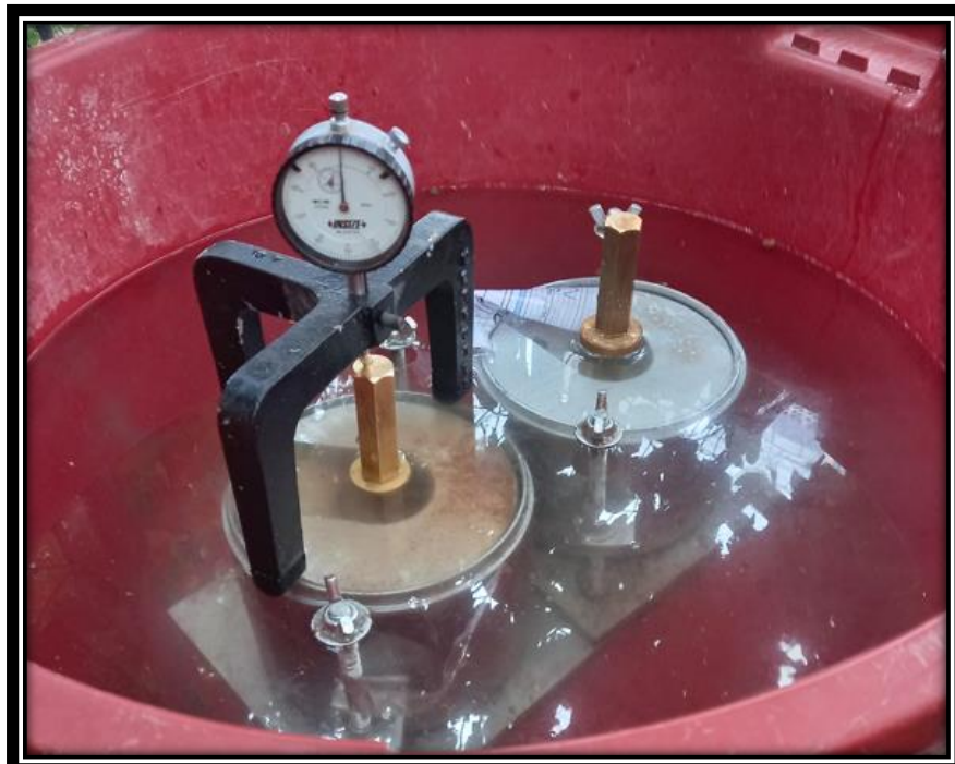
Figura 49: Inmersión de muestra, en H 2 O para determinar expansión.
