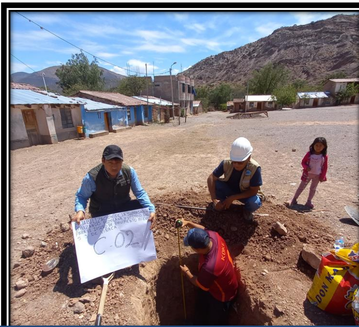
Figura 17: Calicata C-2 extrayendo la muestra
