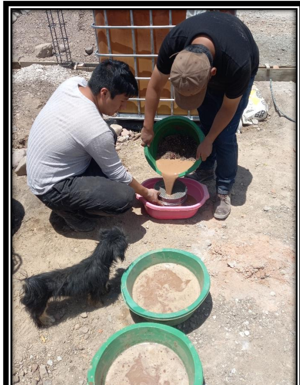
Figura 31: Lavado de cada muestra en cada calicata, pasante el tamiz #200
