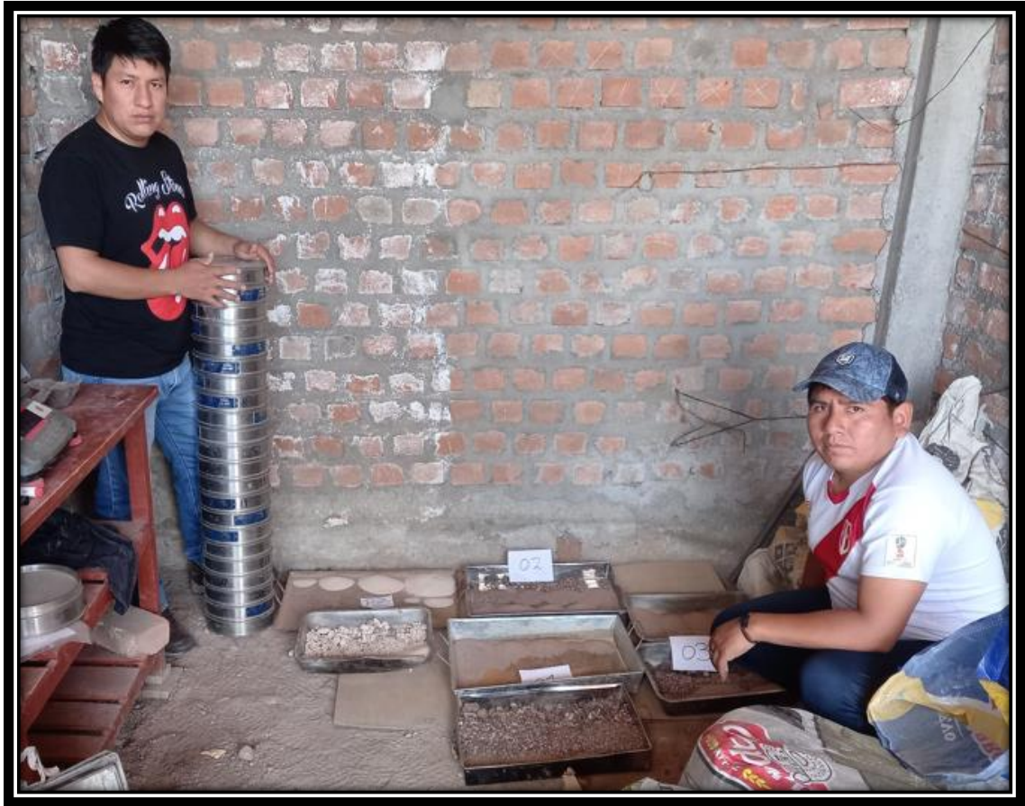
Figura 37: Trabajo de tamizado de todas las calicatas.
