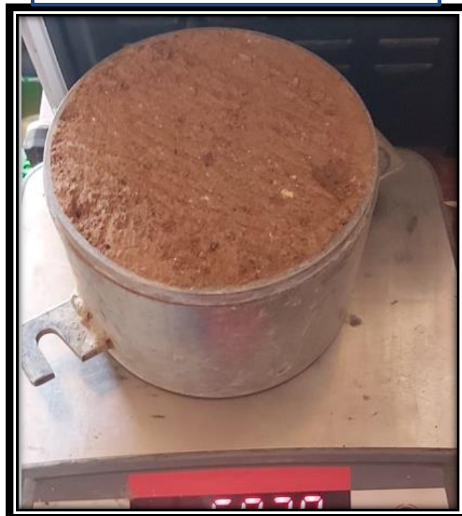
Figura 41: CC-02, pesado de molde más la muestra del Proctor modificado.
