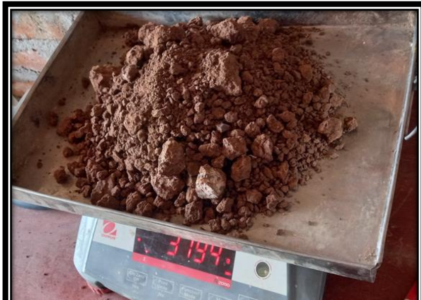
Figura 38: CC-02, pesado de material natural para el Proctor modificado.
