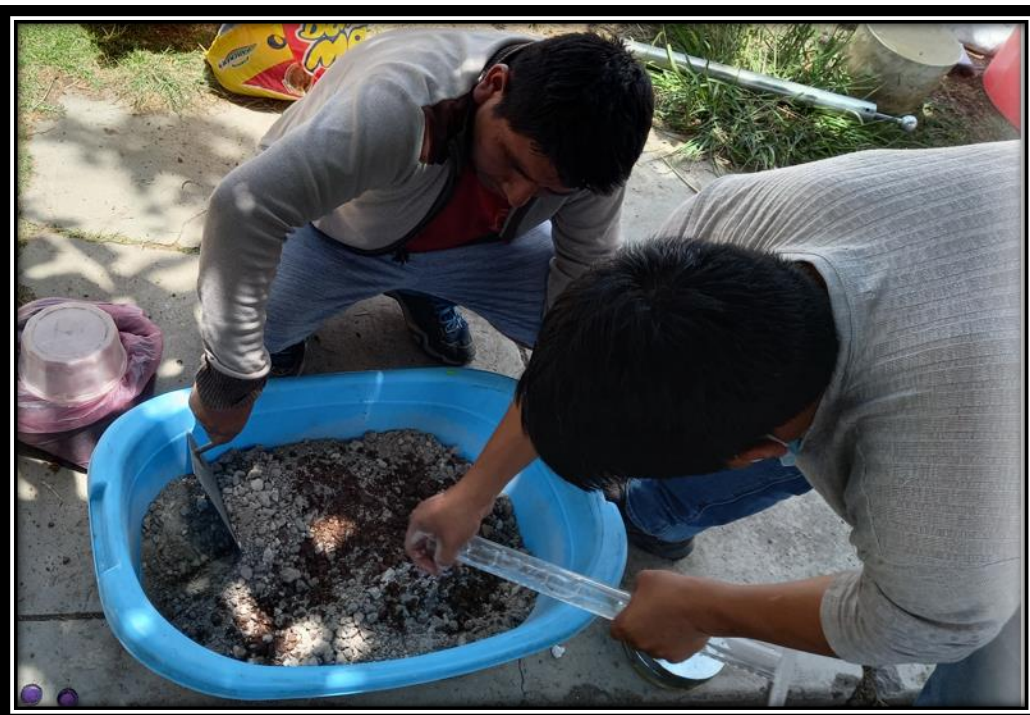
Figura 47: CC-02 muestra natural + puzolana + vidrio polvorizado + agua para el CBR.
