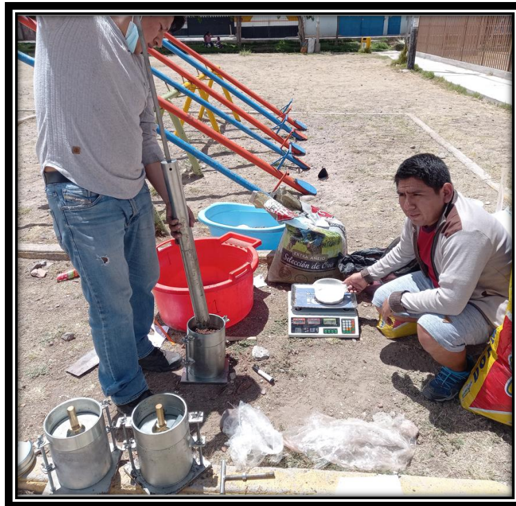
Figura 45: CC-02, realizado a 56 golpes, 25 golpes y 12 golpes en muestra crítica (ensayo de CBR).
