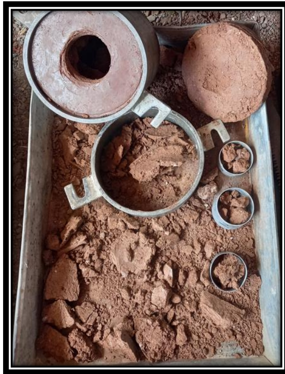
Figura 42: CC-02, extracción de la muestra para determinar la humedad de la muestra crítica.
