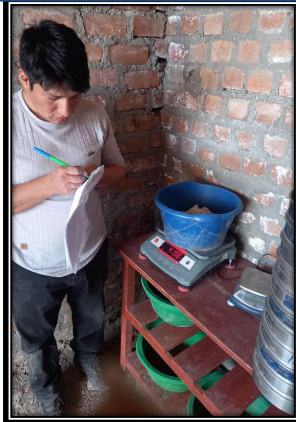
Figura 30: Pesado de cada muestra de calicata.
