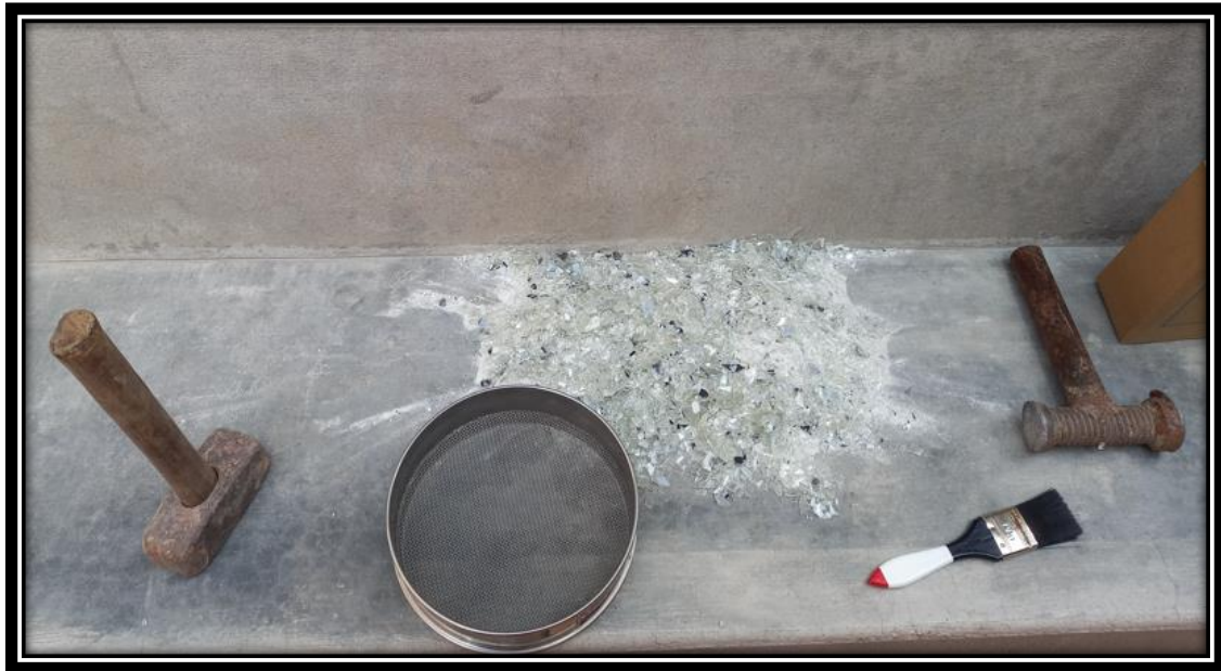
Figura 25: Trituración de las botellas.
