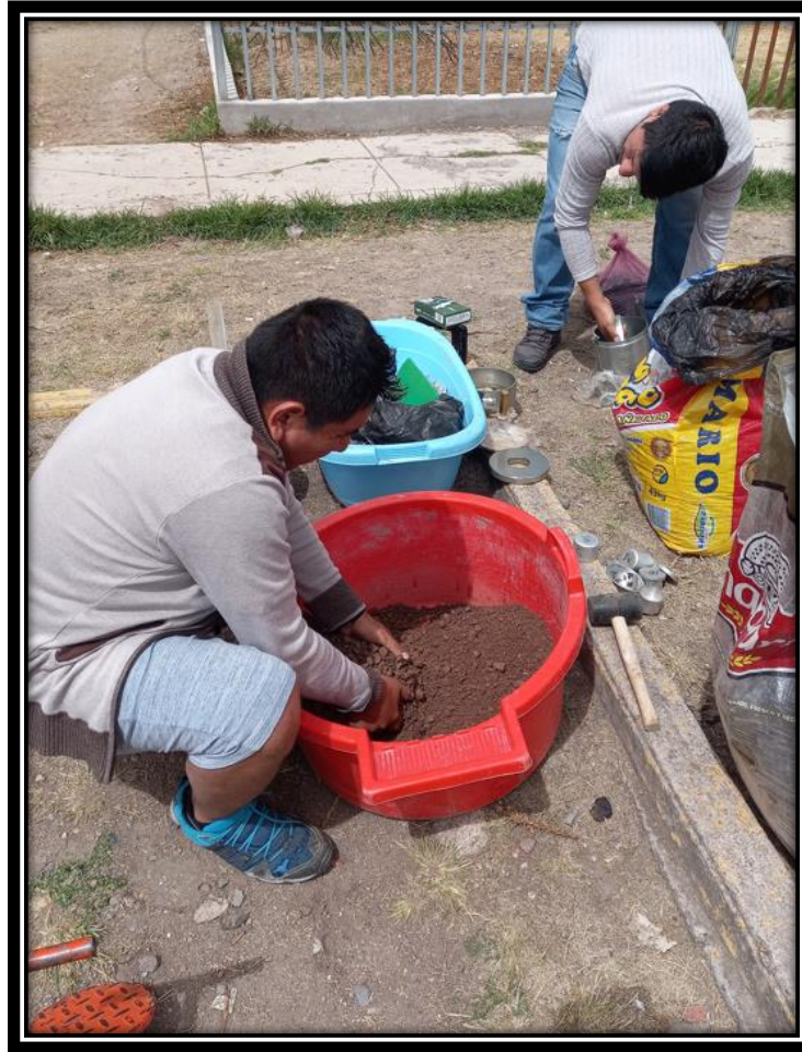
Figura 44: CC-02, preparación del material para el CBR.
