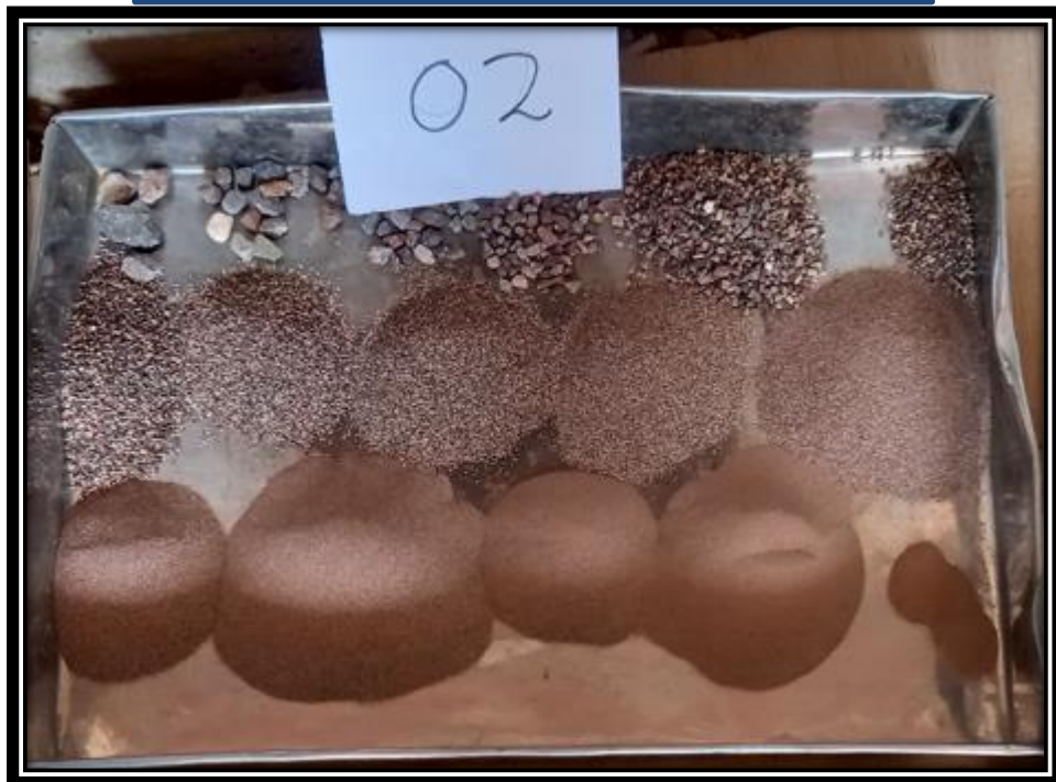
Figura 34: Tamizado de la CC-02.
