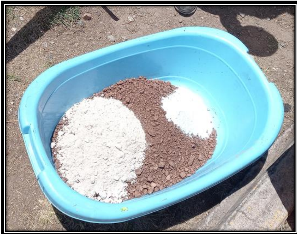
Figura 46: CC-02 muestra natural + puzolana + vidrio polvorizado para el CBR.
