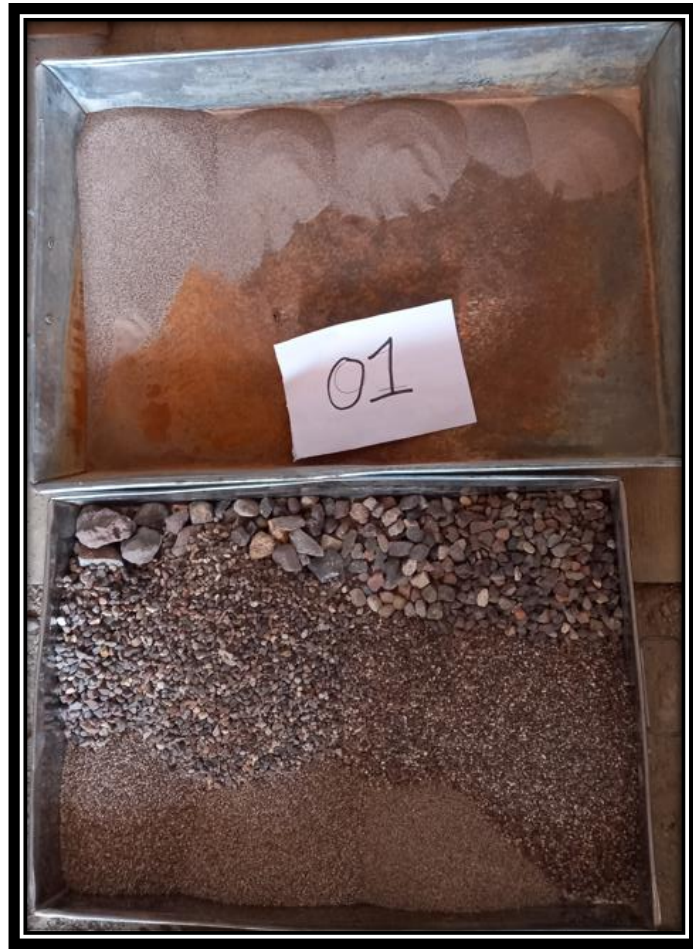
Figura 33: Tamizado de la CC-01.
