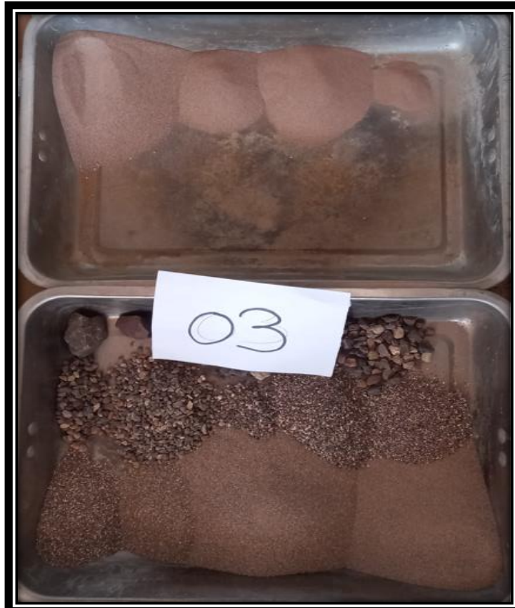
Figura 35: Tamizado de la CC-03.
