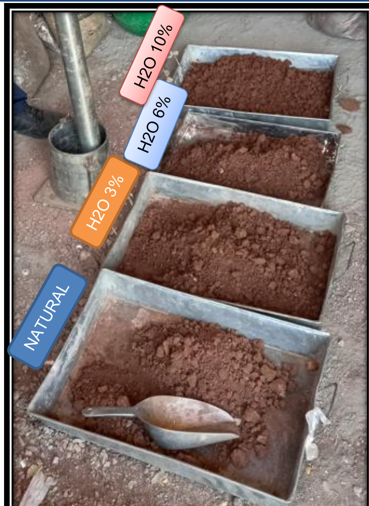
Figura 39: CC-02, Preparación de material para el Proctor modificado.
