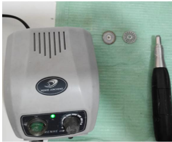
Preparacion del motor de baja velocidad con discos diamantados.
